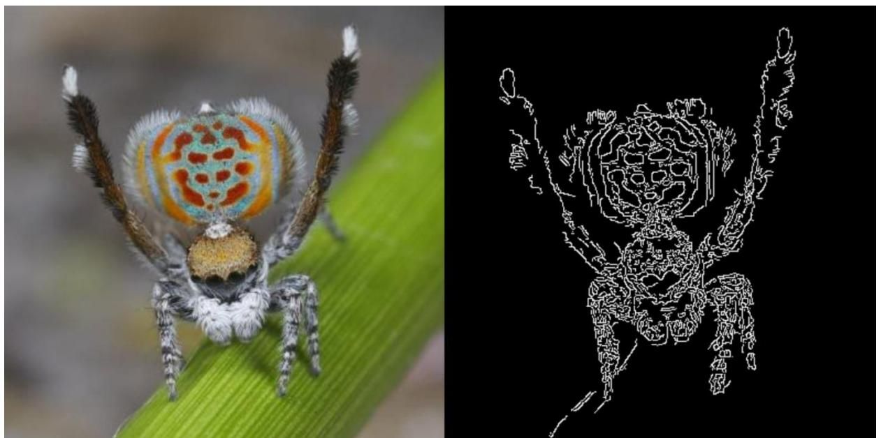
*Slika 2.2. Ulaz(ljevo) i izlaz(desno) Canny algoritma[3]*
