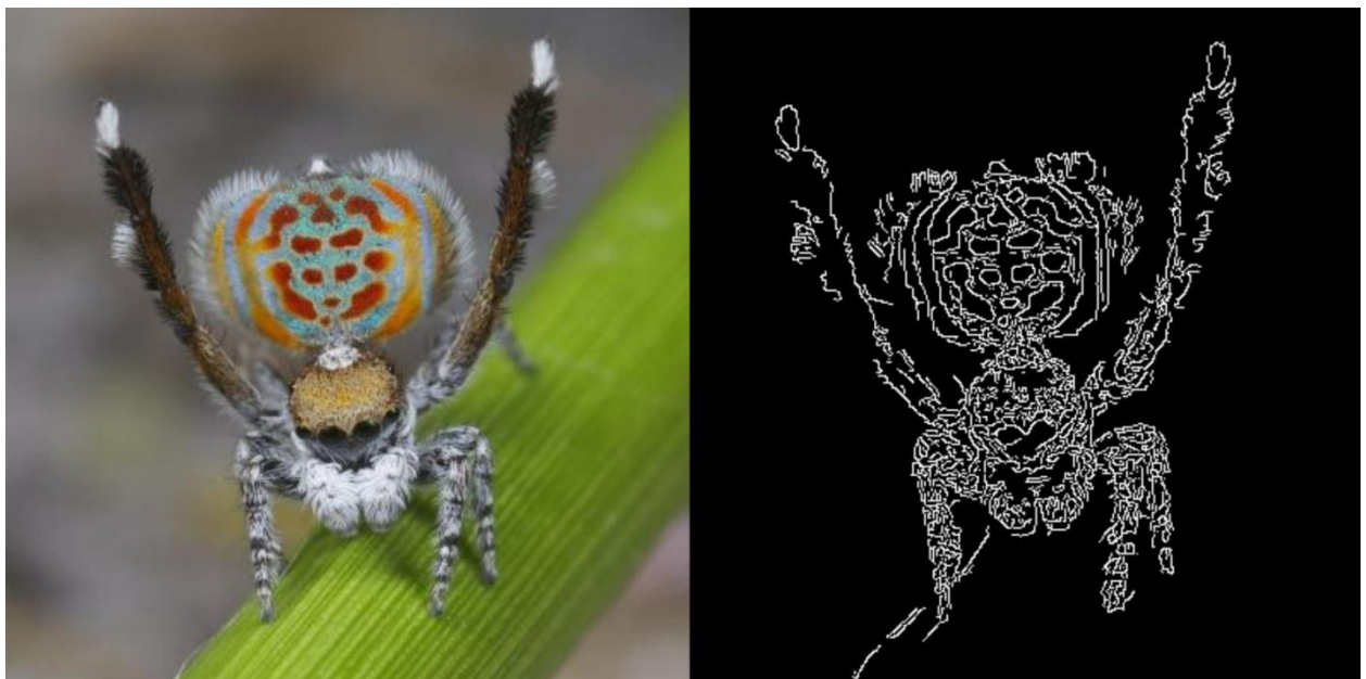
Slika 2.2. Ulaz(lijevo) i izlaz(desno) Canny algoritma[3]
