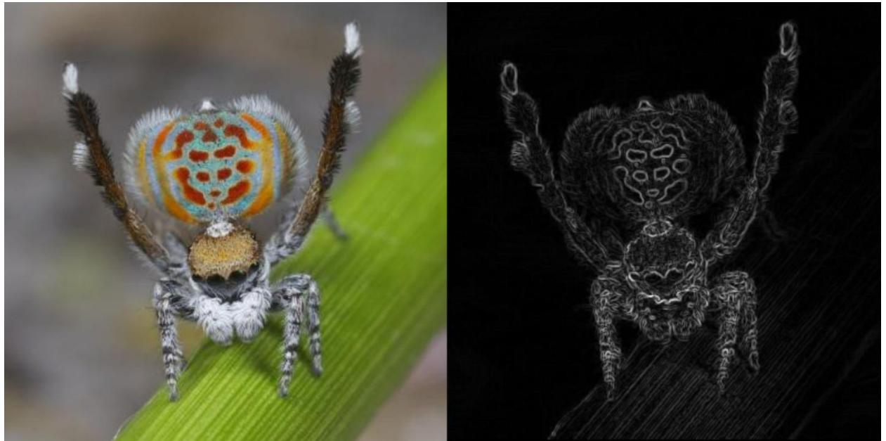
*Slika 2.1. Ulaz(ljevo) i izlaz(desno) Sobel algoritma[3]*
