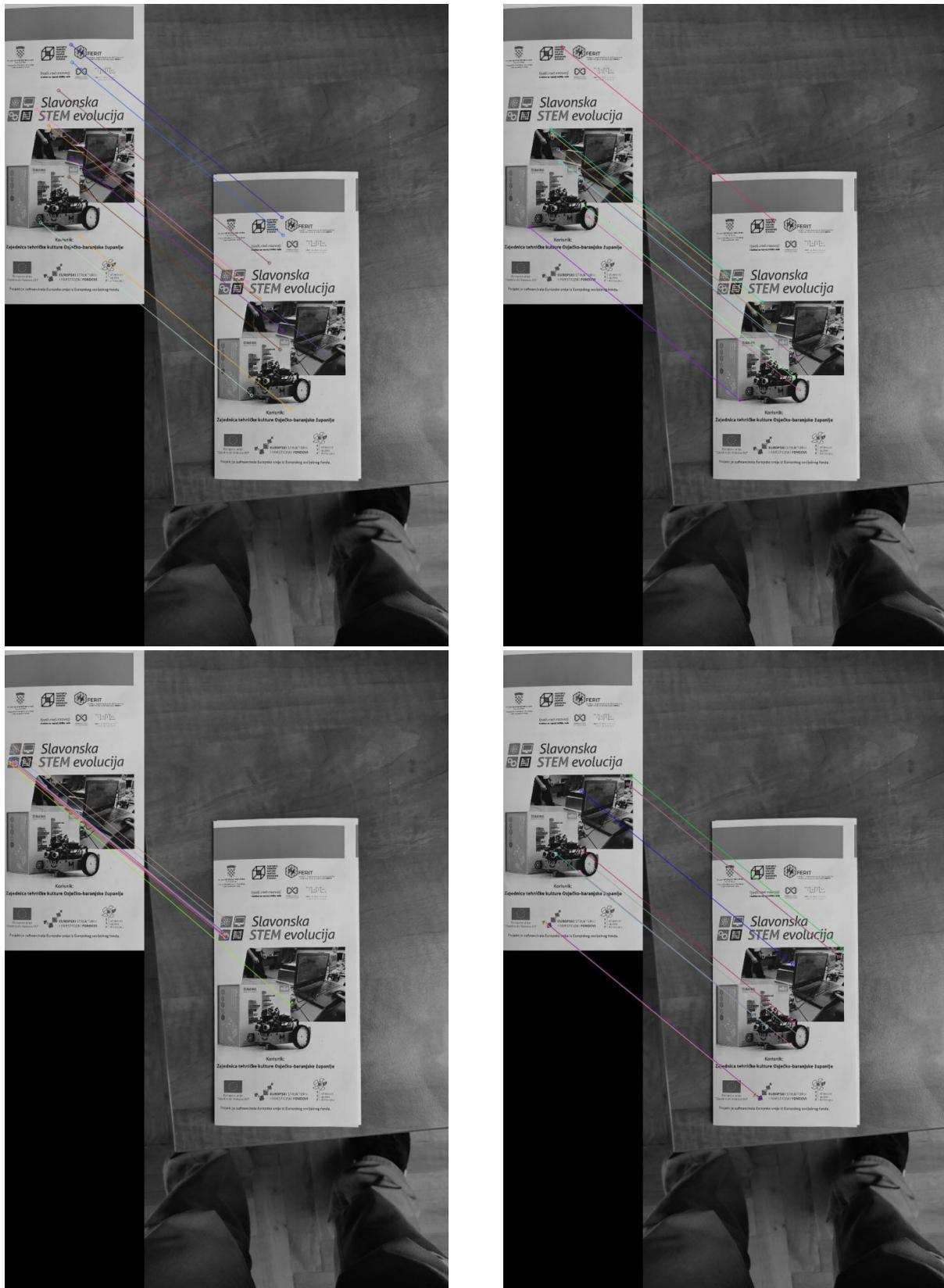
*Slika 4.5. Rezultati na slici: gore lijevo FREAK, gore desno BRISK, dolje lijevo SIFT, dolje desno SURF*
