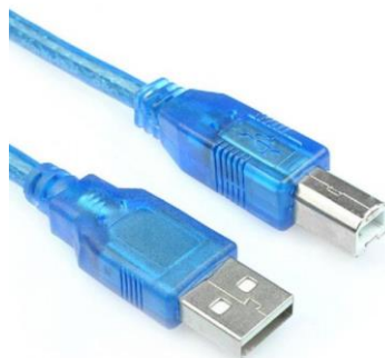
Slika 3.19. Primjer USB kabela [15]
