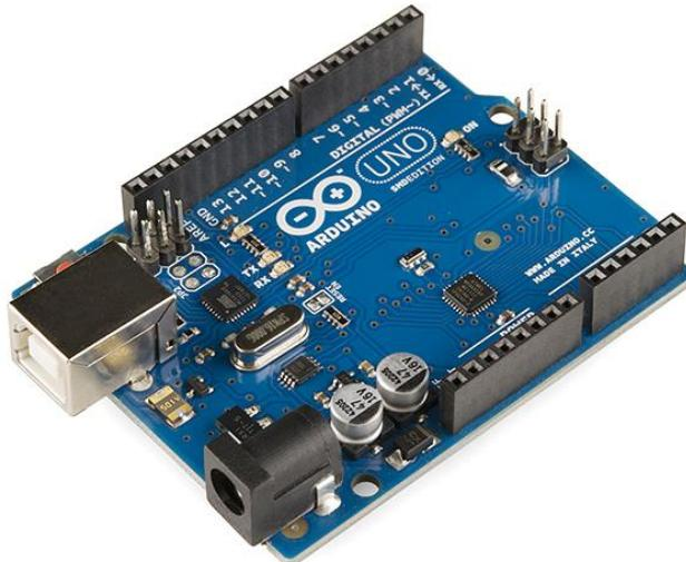
Slika 3.1. Mikrokontroler arduino UNO [4]
