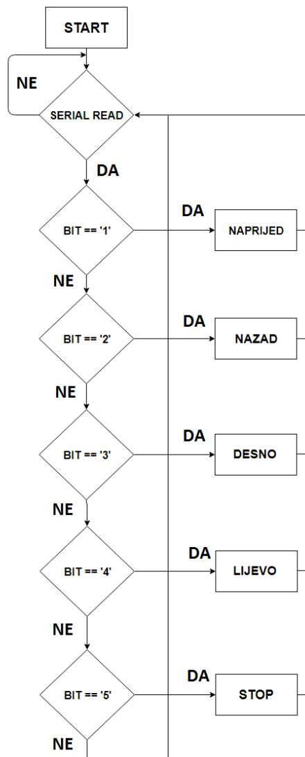
Slika 3.14. Blok dijagram programa za upravljanje mobilnim sustavom
