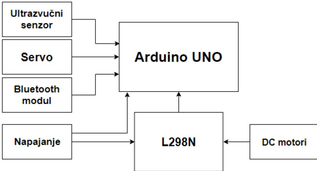
Slika 2.2. Blok dijagram mobilnog sustava
