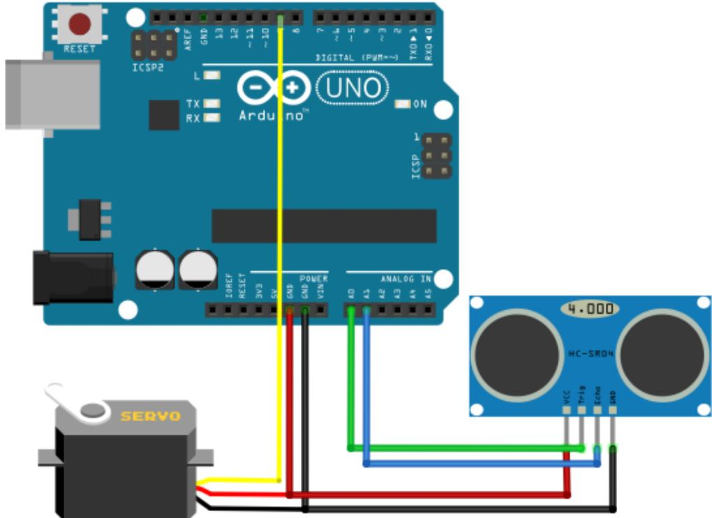
Slika 3.10. Shema spajanja servo motora i ultrazvučnog senzora sa UNO-m
