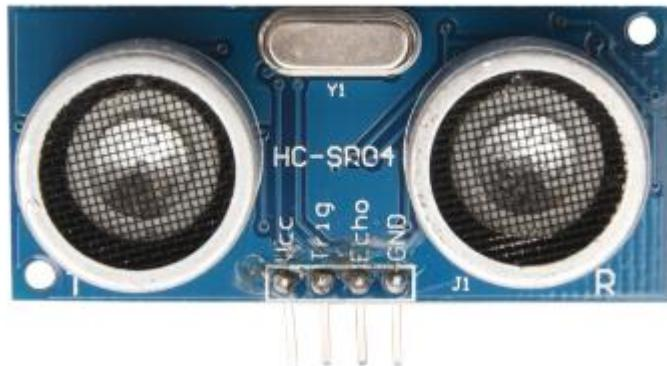
Slika 3.2. HC-SR04 Ultrazvučni senzor [5]
