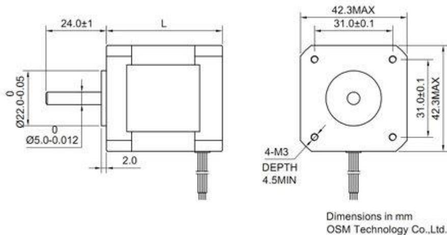
Slika 3.19. Dimenzije Nema 17 koračnog motora [36]
