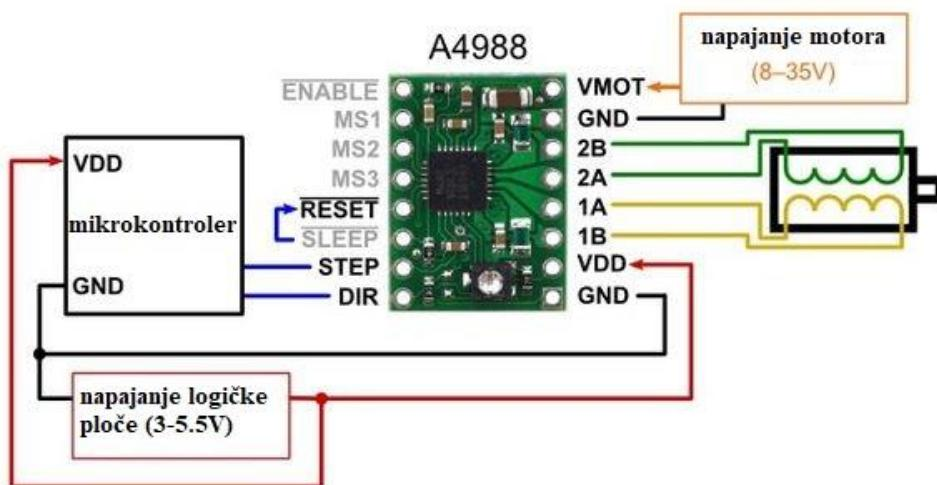
Slika 3.13. A4988 pogonski modul za koračni motor [18]
