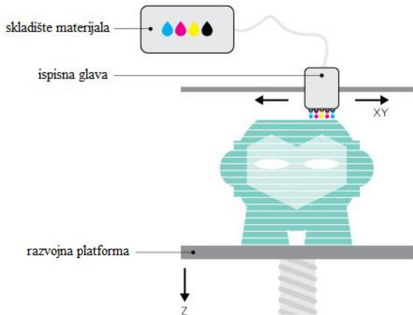
Slika 2.8. Prikaz tehnologije ispis nanošenjem materijala mlazom [16]
