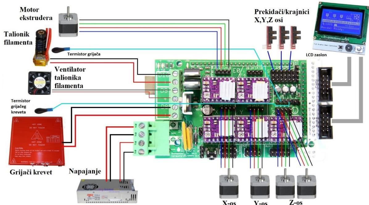
Slika 3.9. Montažna shema 3D pisača [31]
