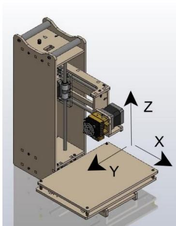
2.11. Primjer kartezijev koordinatnog sustava na FFD printeru
