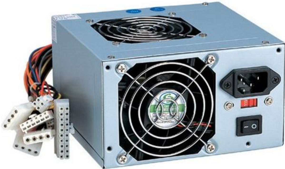
Slika 3.14. Napajanje od 420 wata [33]
