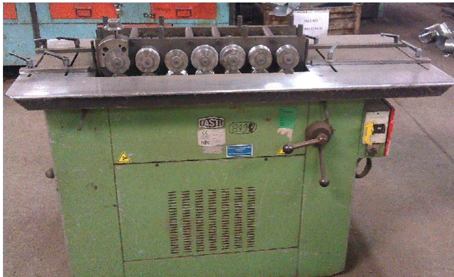
Slika 7.1 – Stroj za oblikovanje šavova
