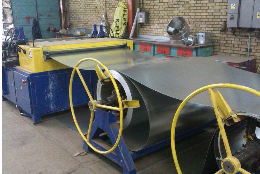
Slika 5.2 – Odmotač lima na stroju
