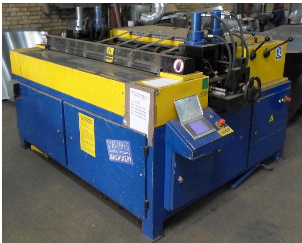
Slika 5.1 – Stroj za izradu pravokutnih cijevi
