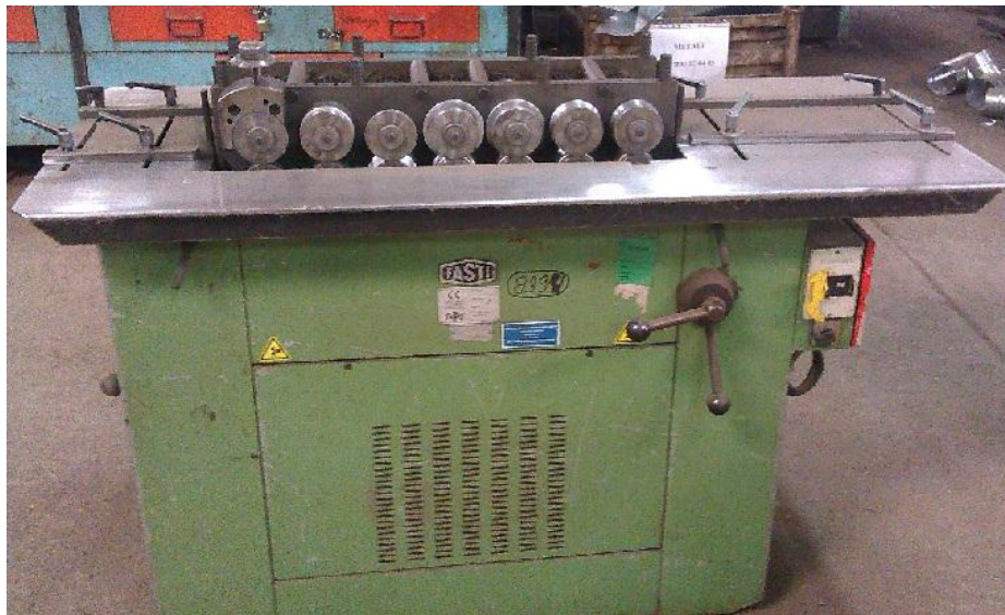
Slika 7.1 – Stroj za oblikovanje šavova
