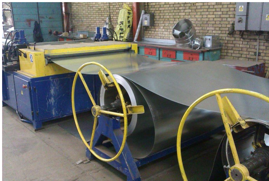
Slika 5.2 – Odmotač lima na stroju
