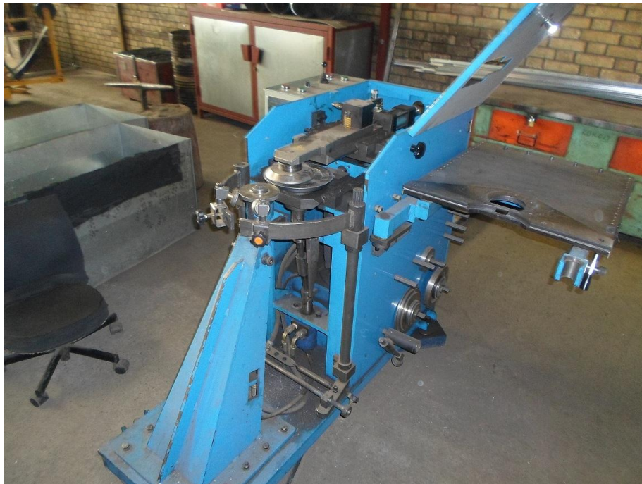
Slika 4.1 – Stroj za izradu koljena cijevi 1250
