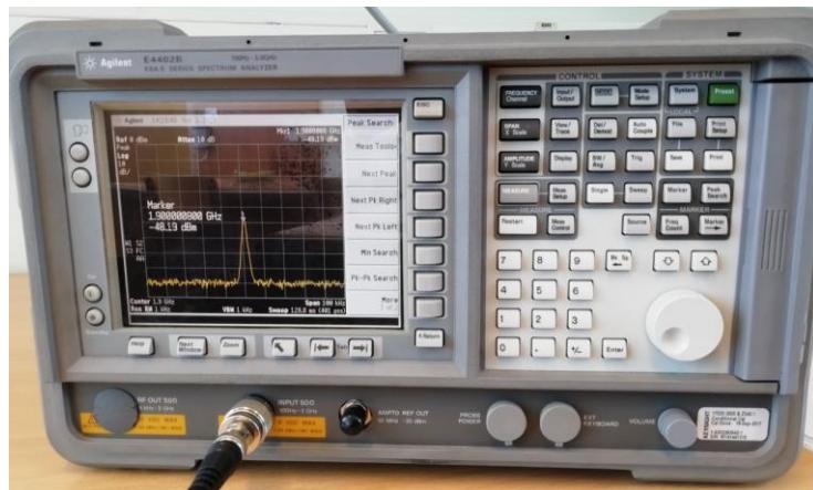
*Slika 8.14. Spektralni analizator Agilent 4402B*
