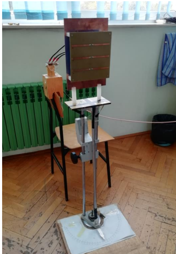
Slika 8.10. Odašiljačka antena na konstrukciji
