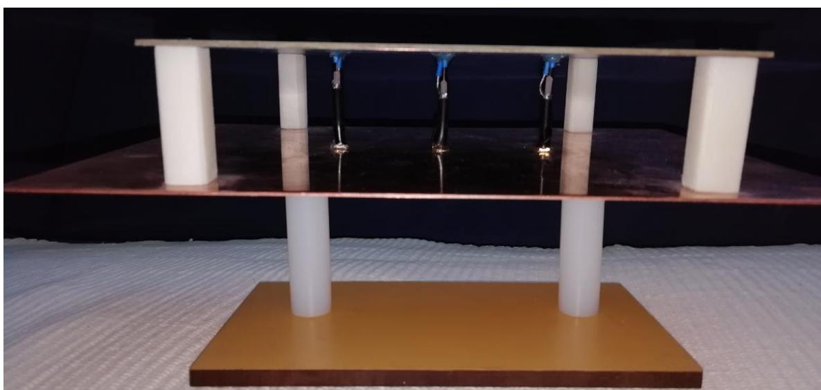
*Slika 8.2. horizontalni prikaz niza 3 dipol antene na nevodljivoj površini s reflektorm*
