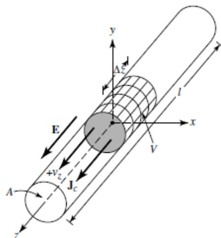
*Slika 3.3. Naboј ravnomjerno raspoređen u kružnom presjeku žice cilindričnog oblika [3]*
