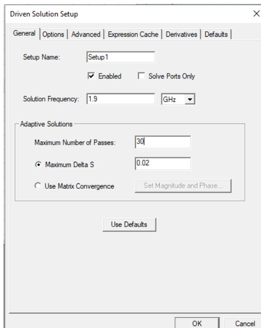
Slika 7.23. Postavljanje centralne frekvencije te korake za simulaciju
