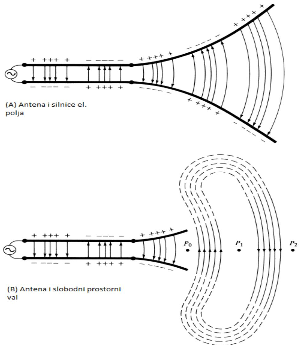
**Slika 5.5.** Izvor, prijenosna linija, antena, i odvajanje silnica električnog polja [3]
