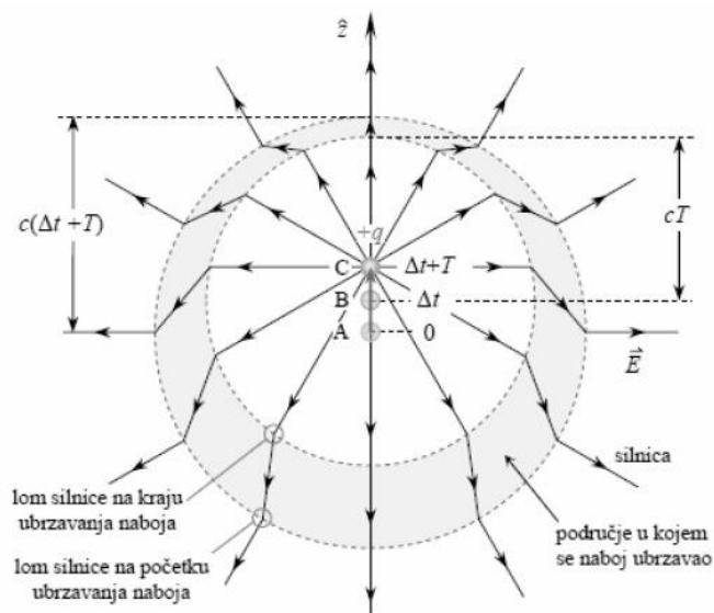
Slika 1.1. Silnice električnog polja nastale prilikom ubrzanja naboja [2]
