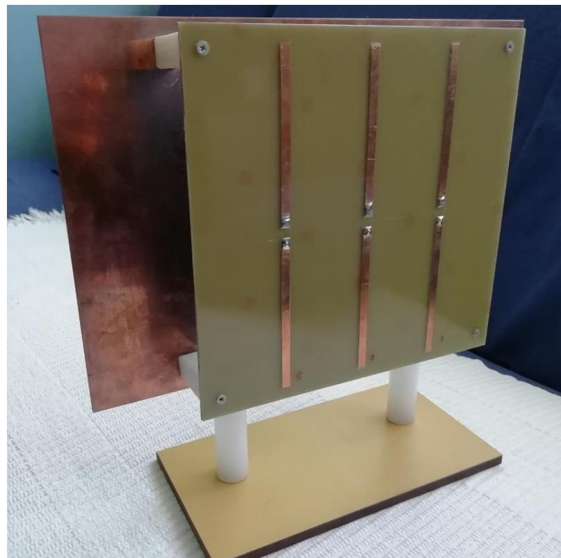
*Slika 8.1. okomiti prikaz niza 3 dipol antene na nevodljivoj površini s reflektorm*
