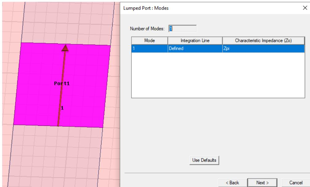
Slika 7.19. Odabiranje dvije priključne točke na prorezu za dobivanje Lumped Porta
