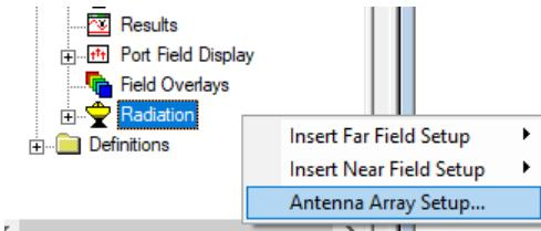
*Slika 7.26. Odabiranje te postavljanje instalacije antenskih nizova*
