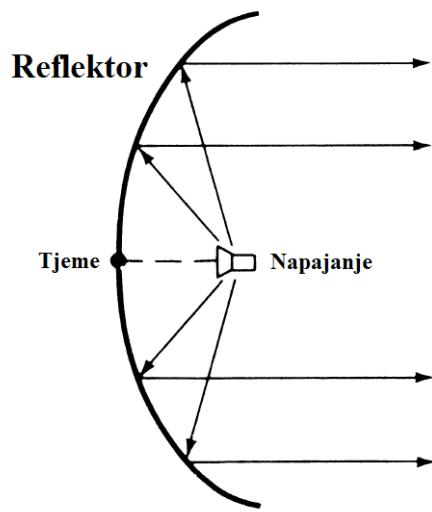
*Slika 5.3. Parabolni reflektor [3]*
