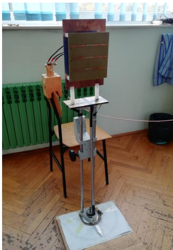
*Slika 8.10. Odašiljačka antena na konstrukciji*
