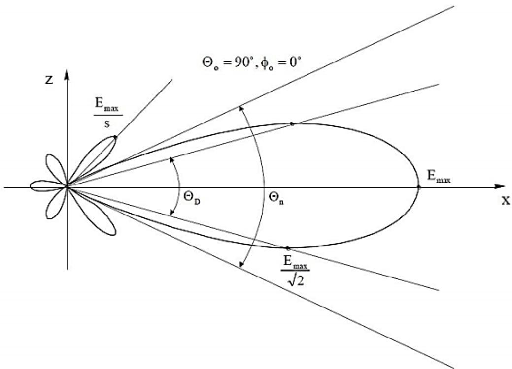
*Slika 3.3. Vertikalni dijagram zračenja s karakterističnim veličinama [5]*
