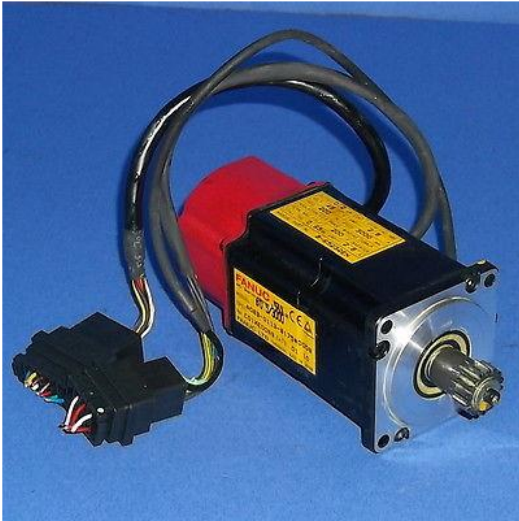
Sl. 4.10. Motor za X i Z osi model Fanuc \alpha 8\beta i.
