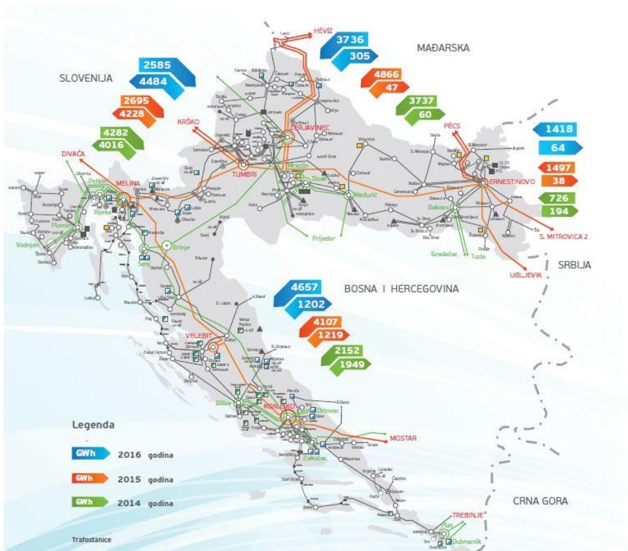
Slika 3.8. Shema hrvatskog elektroenergetskog sustava s razmjenom energije prema susjednim državama [8]
