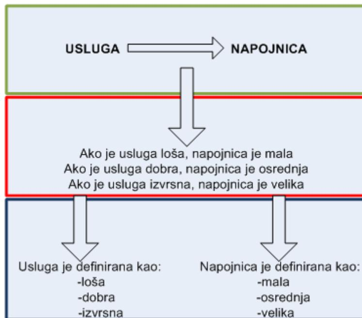
**Slika 2.1.** Primjer neizrazitog zaključivanja povezanošću napojnice i dobivene usluge
