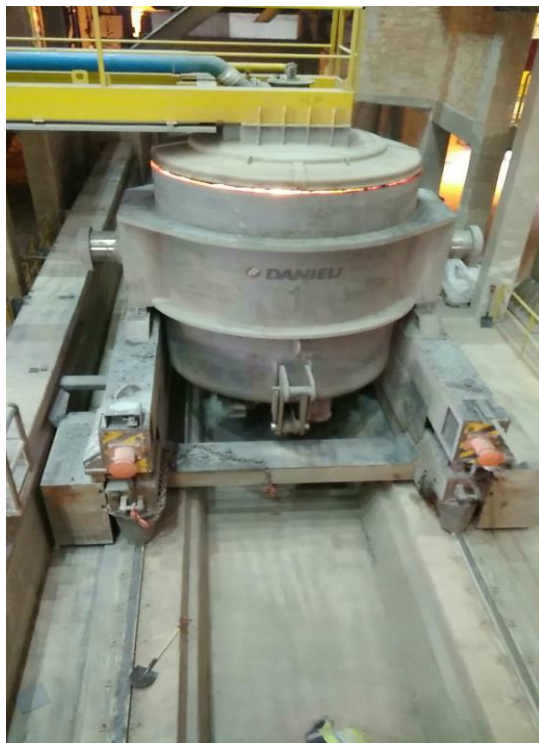
Sl.3.1. Kolica s loncem smještena na tračnice
