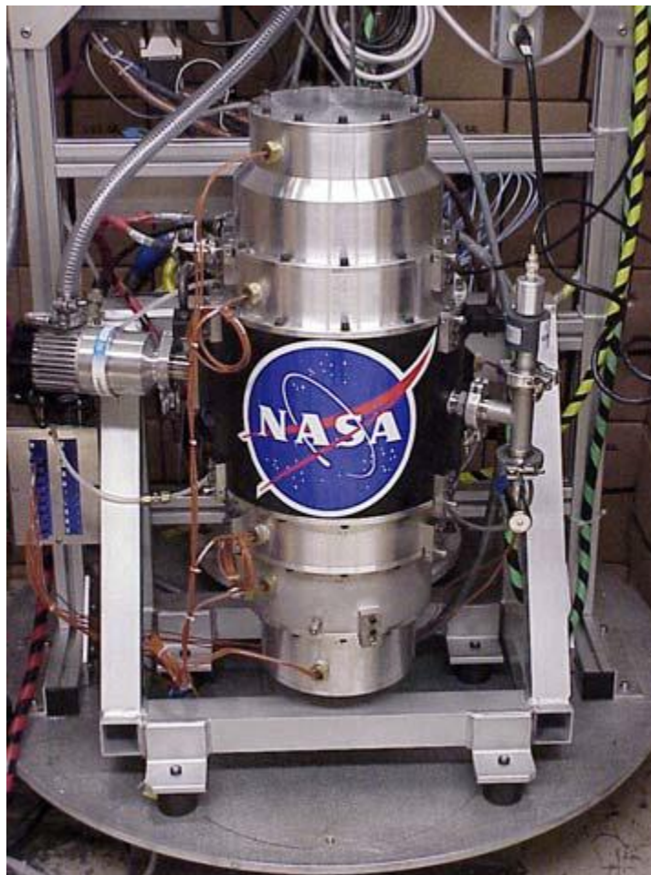
Slika 3.3 Prikaz flywheel modula i zamašnjaka
