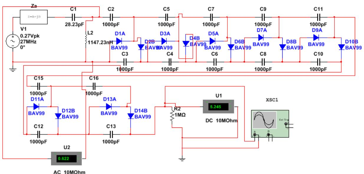
**Sl. 4.2.** Shematski prikaz RF prijemnika u sustavu bežičnog prijenosa energije
