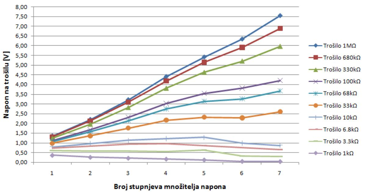
**Sl.6.1..** Grafički prikaz ovisnosti izlaznog napona o otporu trošila prilikom laboratorijskih mjerena
