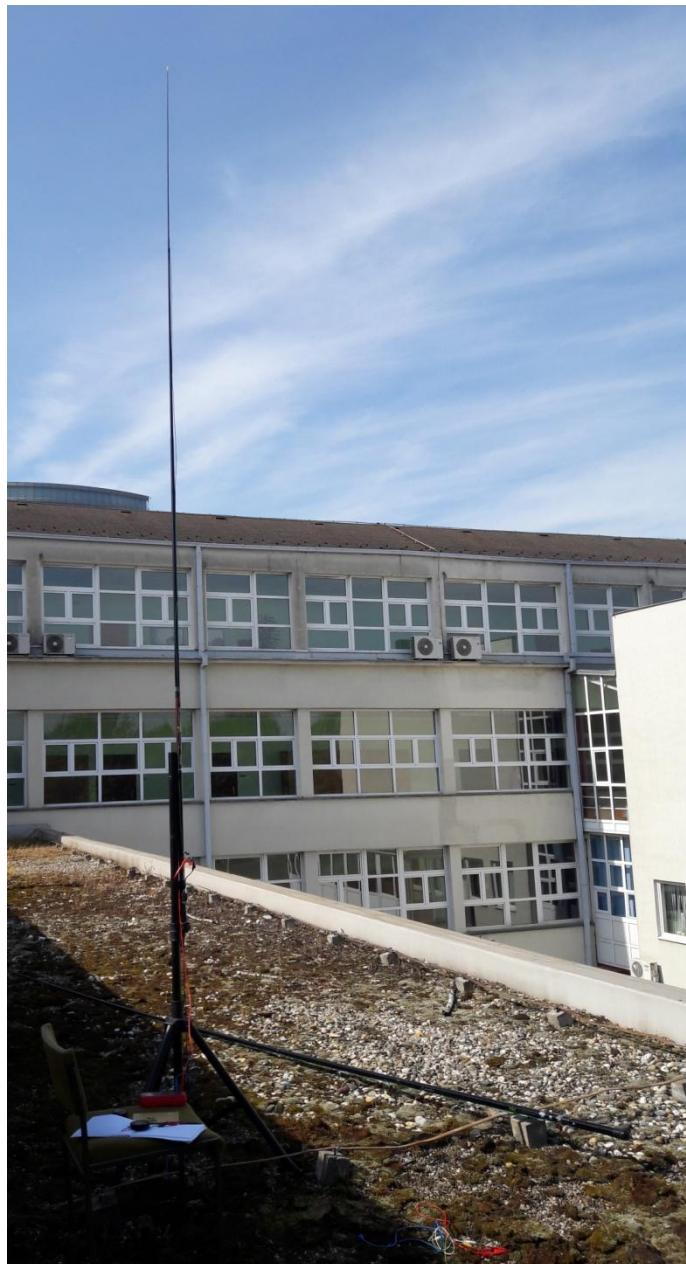
**Sl.6.2.**Četvrvalni monopol u sklopu RF prijemnika u procesu mjerjenja
