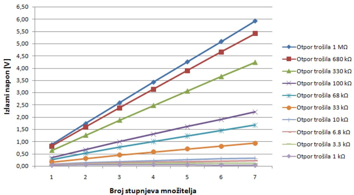
Sl.4.7. Grafički prikaz ovisnosti izlaznog napona o otporu trošila
