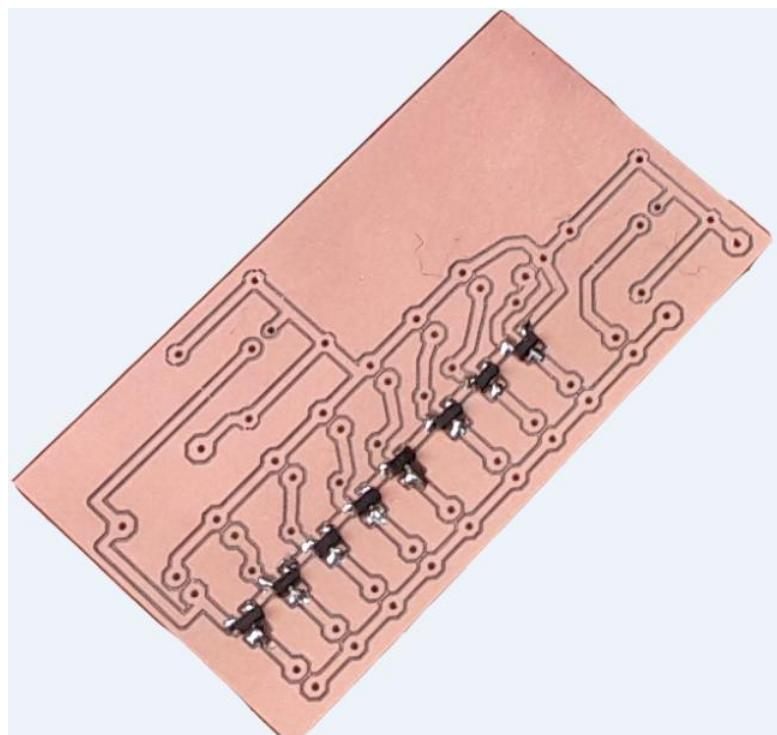
**Sl. 5.3.**Izradena PCB pločica za implementaciju RF prijemnika u procesu lemljenja komponenti na istoj
