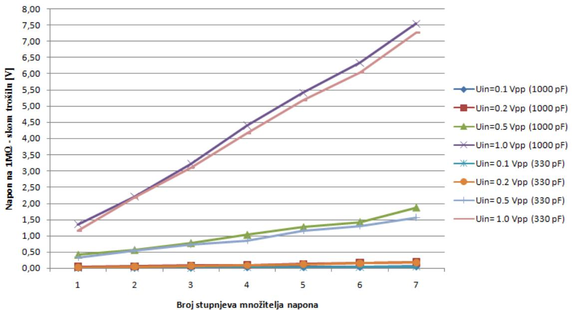
Sl.6.2.Prikaz utjecaja iznosa stupnjevskih kapaciteta na izlazni napon
