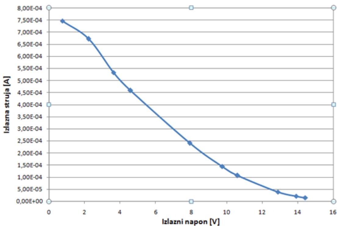
**Sl.6.4.** Grafički prikaz izlazne U-I ovisnosti prilikom laboratorijskog mjerjenja sa ulaznim naponom od 2 Vpp.
