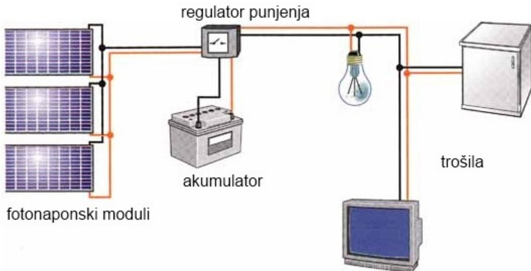
Sl. 2.13. Prikaz autonomnog foto naponskog sustava [12]
