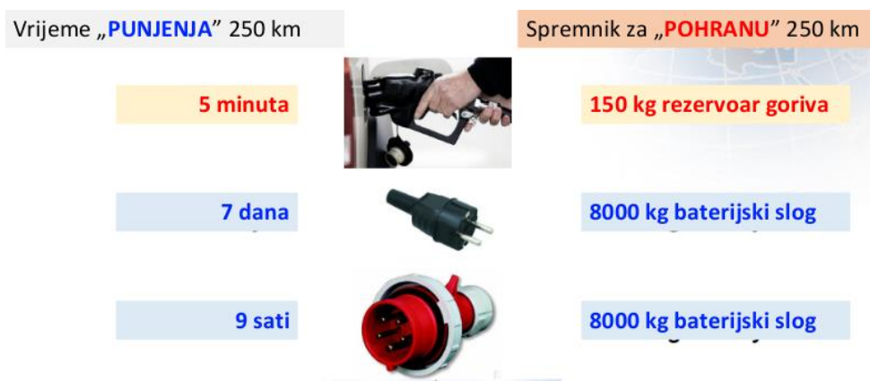
Slika 3.17. Usporedba potrebnog vremena za punjenje vozila energijom potrebnom da vozilo prijeđe put od 250km, te težina spremnika energije
