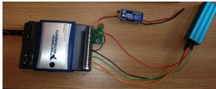
Slika 7.6. ADXL330 akcelerometar spojen sa mjernim čvorom NI WSN – 3202
