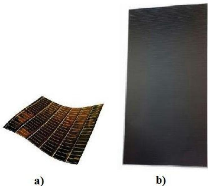
*Slika 3.8.* Fotonaponska čelija od CdTe (a) i panel (b) [19]
