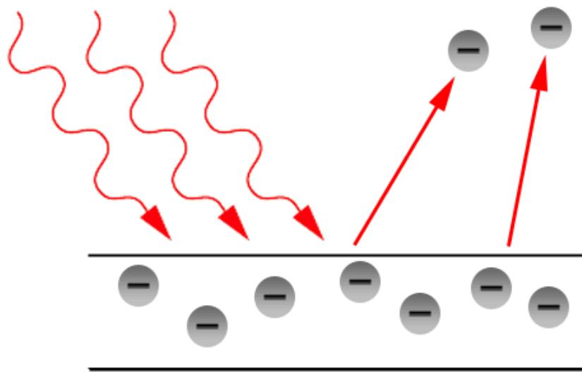
*Slika 2.3.* Prikaz fotoelektričnog efekta [7]
