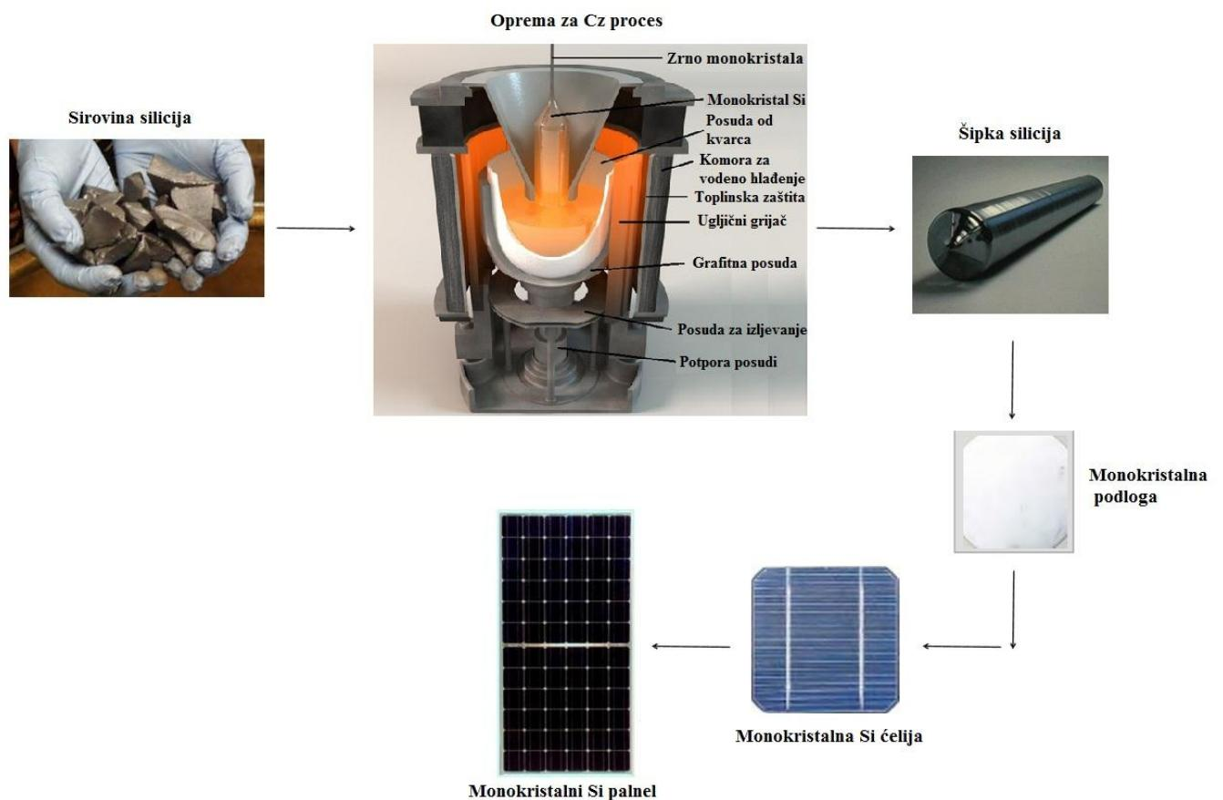
**Slika 3.1.** Prikaz Czochralskijevog procesa proizvodnje mono-Si panela [14]
