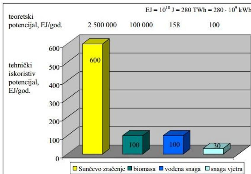
**Slika 1.1.** Teoretski i tehnički potencijal obnovljivih izvora energije [1]
