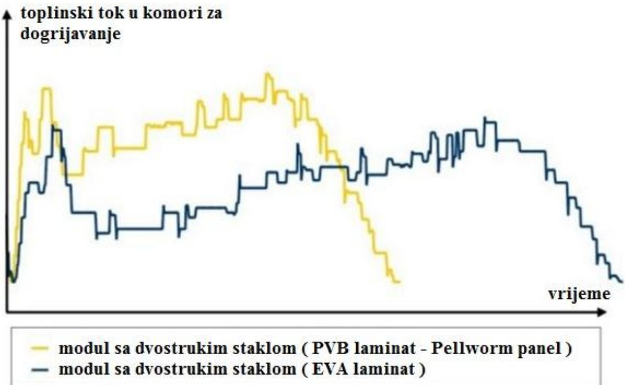
**Slika 4.5.** Toplinski tok u komori za dogorijevanje tijekom termičke obrade panela s otoka Pellworm u usporedbi sa panelima sa dvostrukim stakлом drugog proizvođača [26]
