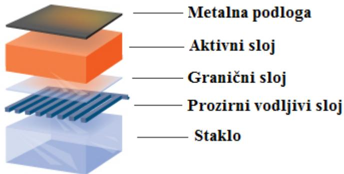
*Slika 3.7.* Struktura CdTe čelije [17]
