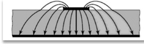
Slika 2.13. Prikaz zatvaranja silnica električnog polja između mikrotrake i uzemljene površine.[2]
