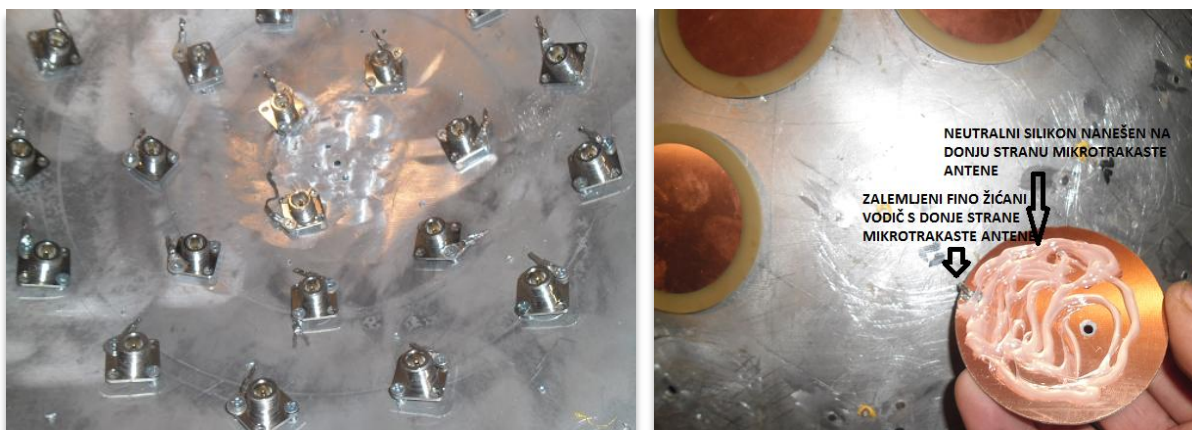
Slika 3.5. a) postavljeni N konektori u unutarnje strane polu sfere, b) priprema antene za postavljanje na polu sferu.
