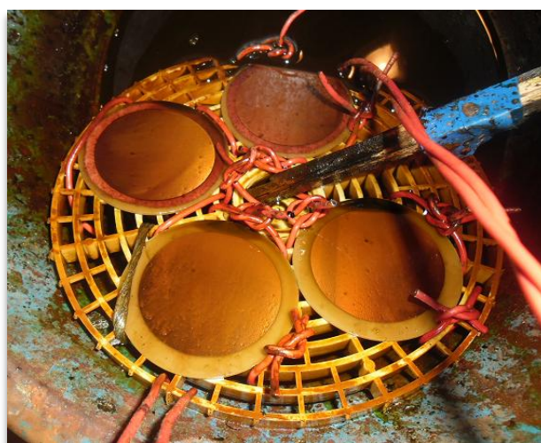
Slika 3.3 Postupak nagrizanja pločica.
