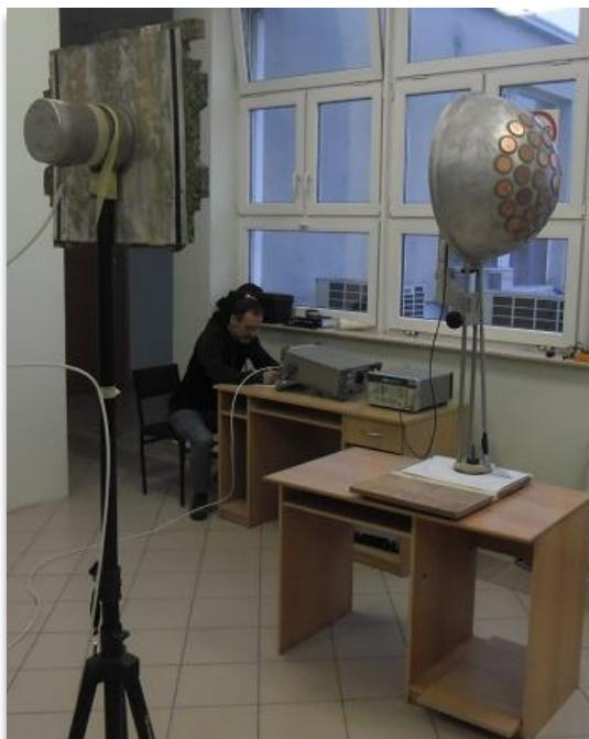
*Slika 4.5. Postava za mjerjenje dijagrama zračenja antenskog niza.*
