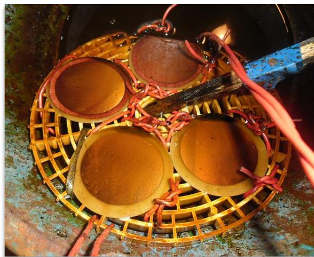
*Slika 3.3 Postupak nagrizanja pločica.*
