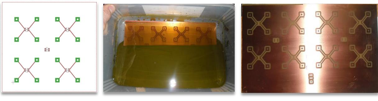
**Slika 3.9.** Postupak izrade tiskane pločice a) dio predloška, b) nagrizanje (jetkanje), c) gotova tiskana pločica
