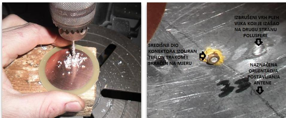
*Slika 3.4 a)postupak bušenja provrta, b) pričvršćen N konektor na metalnu polu sferi.*
