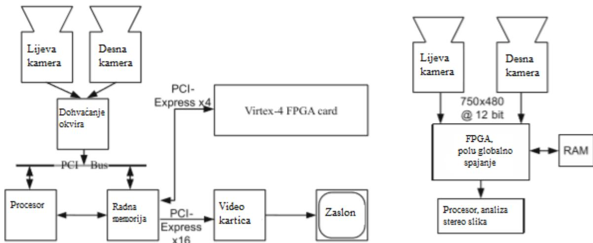
**Slika 2.7.** Blokovski prikaz rješenja, lijevo računalo, desno FPGA
