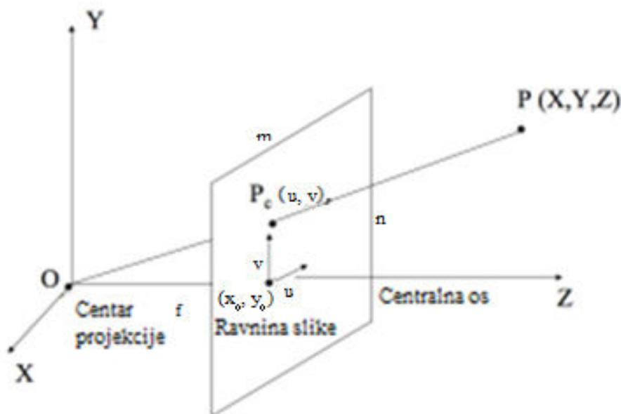
Slika 2.1. Model kamere s točkastim otvorom [2]
