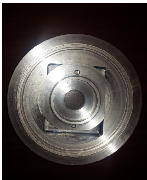
Slika 5.2. Prikaz kućišta ležaja unutar ležajnog štita
