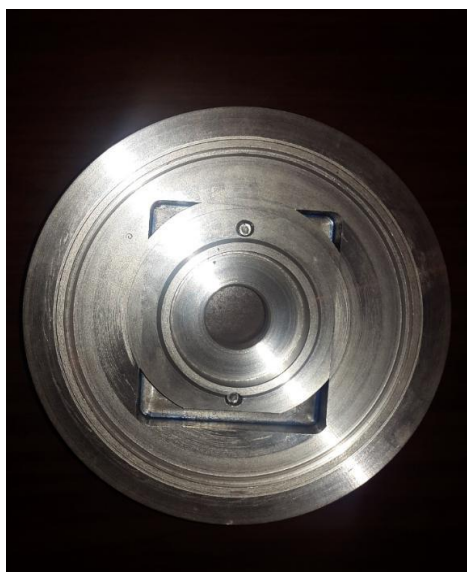
Slika 5.2. Prikaz kućišta ležaja unutar ležajnog štita
