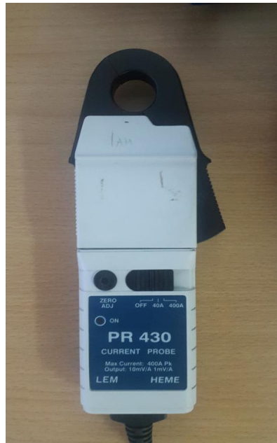
Slika 5.5. strujna kliješta LEM PR430
