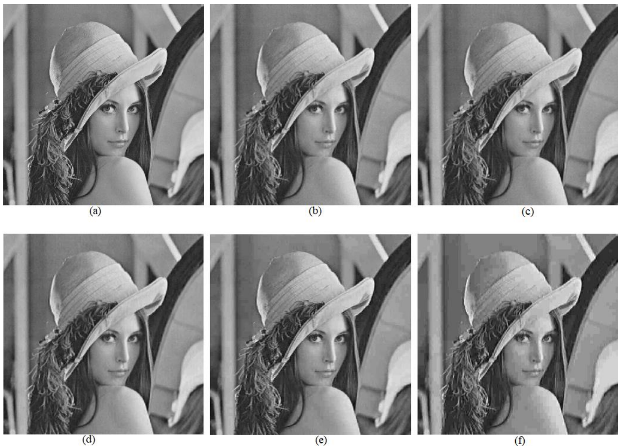
Slika 5.4. Slika „Lena“ rezolucije 512x512 elemenata slike, (a) izvorna slika; te slike komprimirane s faktorom kvalitete: (b) 100, (c) 80, (d) 60, (e) 40, (f) 20.
