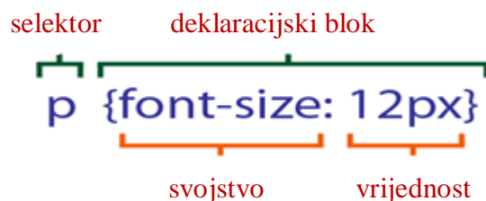
Sl. 2.2. Primjer CSS sintakse [2]
