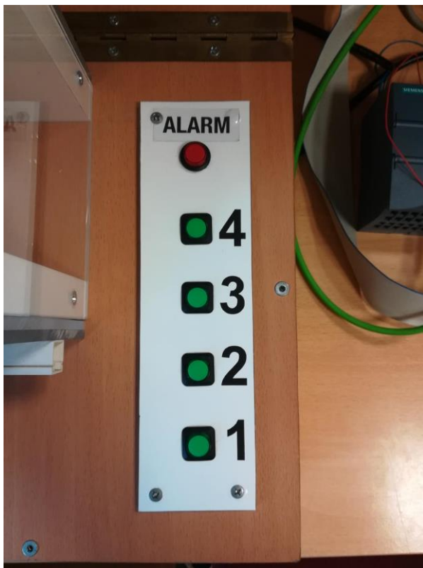
Slika 31 Ploča sa tipkama za pozive katova
