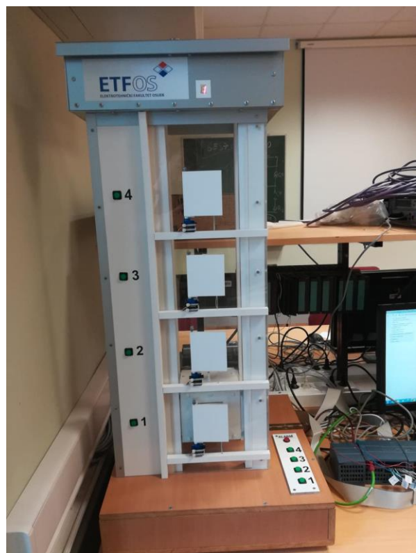
Slika 32 Tipkala za pozive na katove na maketi
