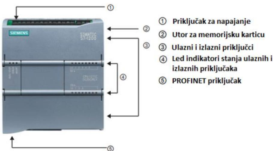
Slika 7 Centralna procesorska jedinica sa PROFINET sučeljem. [3]
