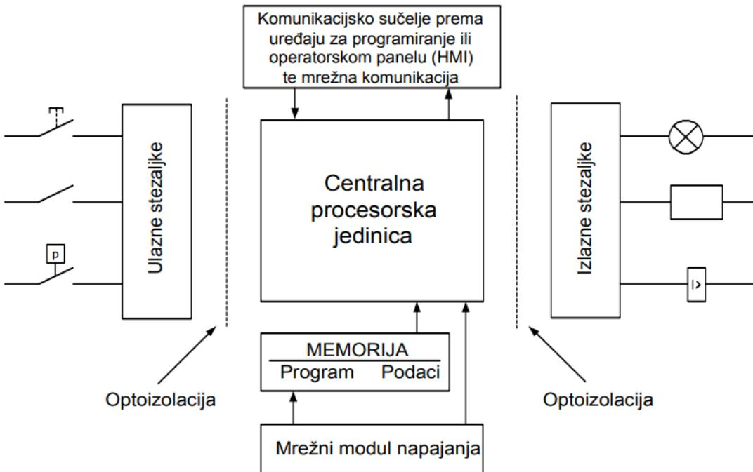
Slika 3 Osnovne celine PLC uređaja [3]
