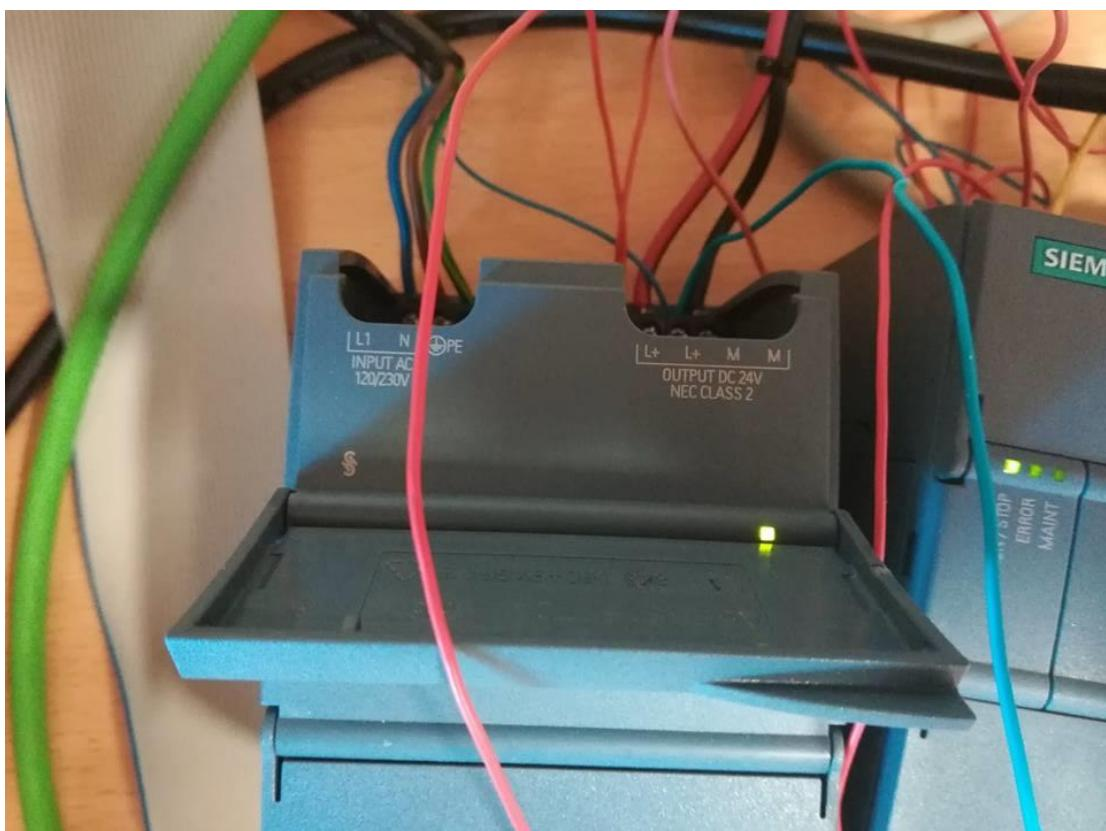
Slika 10 Napajanje PLC uređaja
