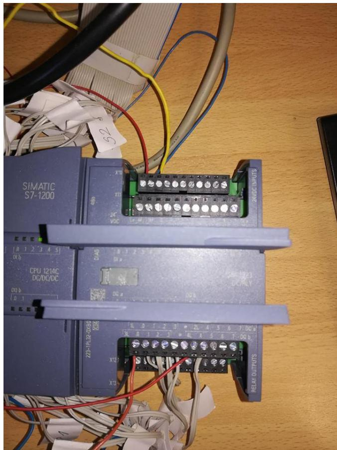
Slika 9 Dodatni signalni modul SM 1223 DI16/DQ16 x relay
