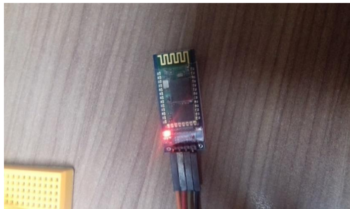
Sl.3.8. HC-06 modul nakon sparivanja
