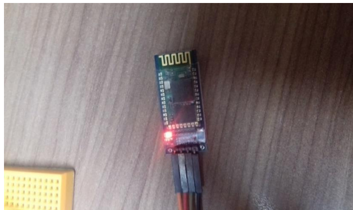
Sl.3.8. HC-06 modul nakon sparivanja
