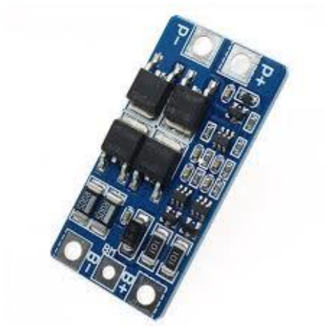
Slika 3.9. HX-2S-JH sustav za upravljanje baterijama.
