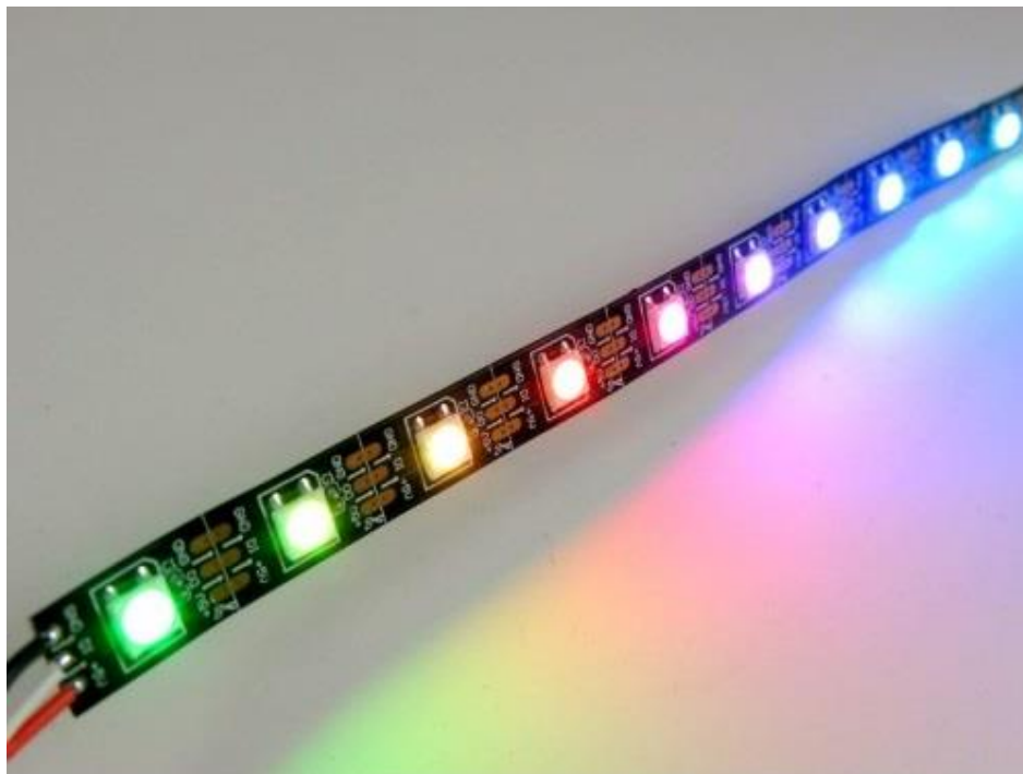
Slika 3.4. WS2812B LED traka.
