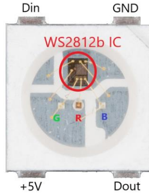
Slika 3.5. Prikaz WS2812B upravljačkog čipa.
