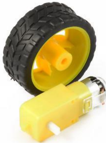
Slika 3.2. Kotač sa DC motorom i reduktorima.
