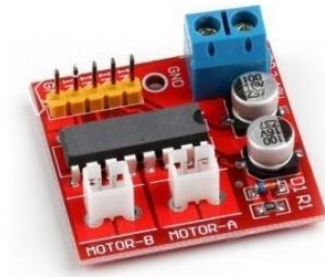
Slika 3.1. H-most za upravljanje DC motora.
