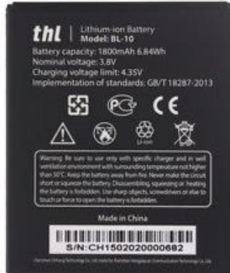
Slika 3.11. Litij-ionska baterija od 1800mAh.
