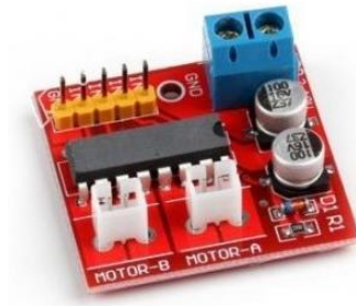
Slika 3.1. H-most za upravljanje DC motora.
