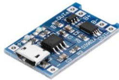
Slika 3.12. TP4056 modul za zaštitu i punjenje baterije.
