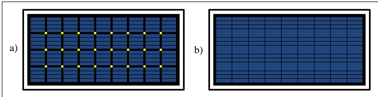
**Slika 2.3:** Fotonaponke čelije: a) monokristalni Silicij, b) polikristalni Silicij.
