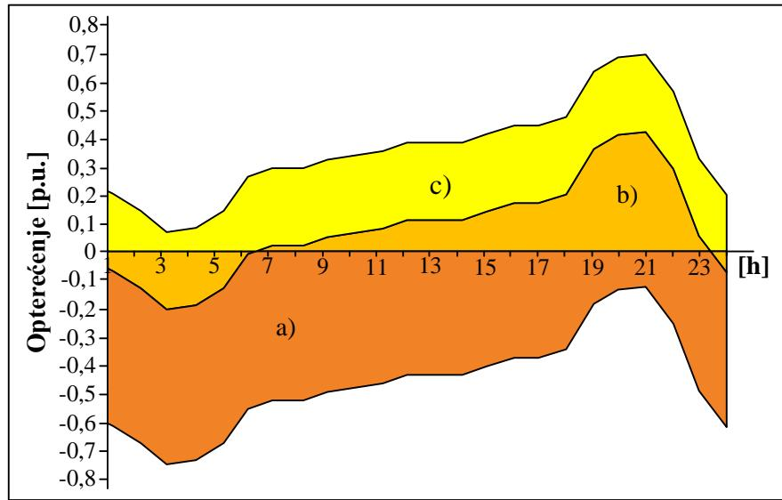
**Slika 3.14:** Ljetni dijagram opterećenja ruralnog voda s tri slučaja; a), b) i c) dnevnog dijagraama proizvodnje bioplinske elektrane, [13].
