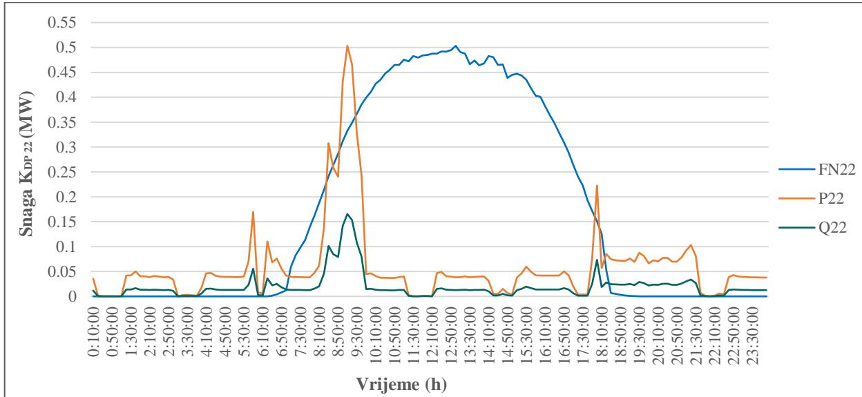
**Slika 4.9:** Profil opterećenja i FNs proizvodnje čvorišta K<sub>DP22</sub>.
