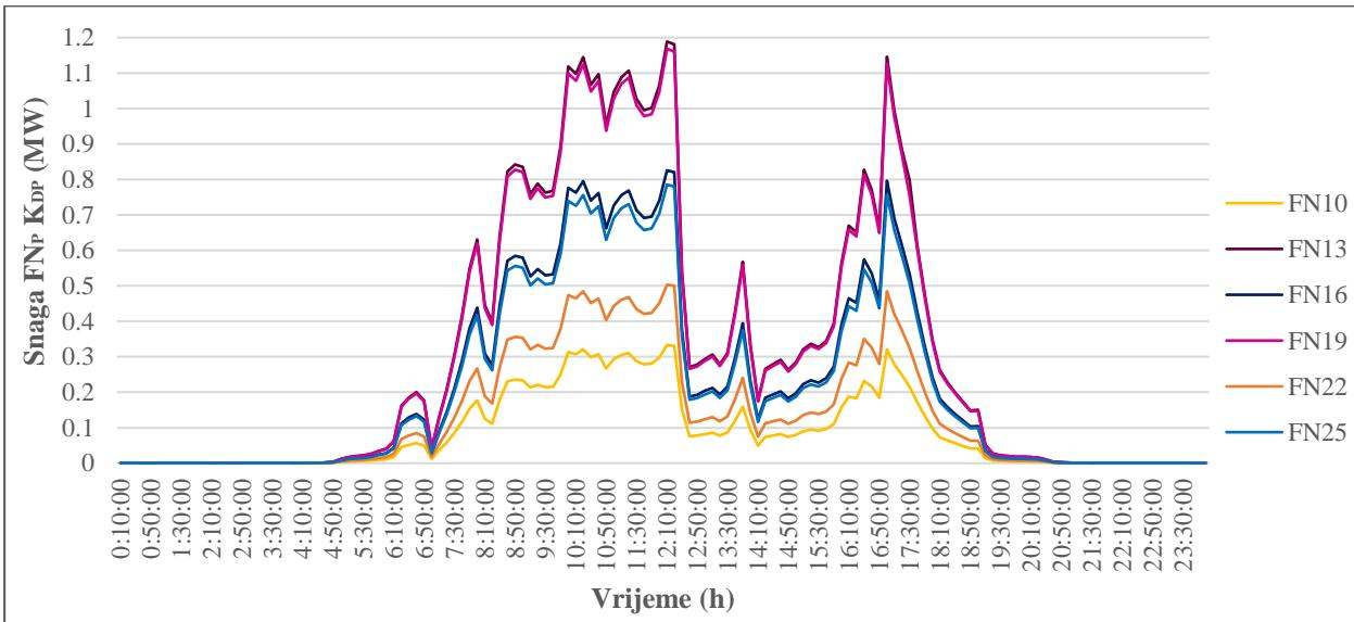
**Slika 4.11:** Skalirana FN<sub>p</sub> proizvodnja prema čvorištu opterećenja K<sub>DPn</sub>.
