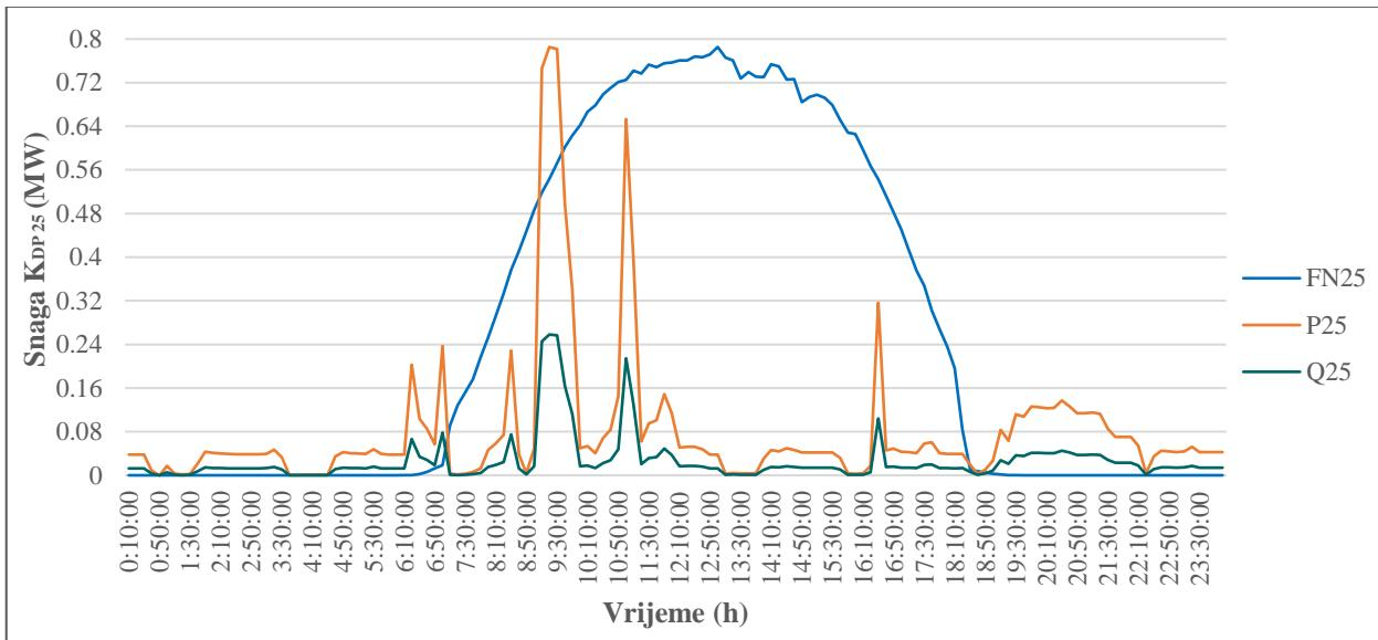
**Slika 4.10:** Profil opterećenja i FNs proizvodnje čvorišta K<sub>DP25</sub>.
