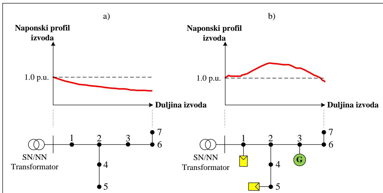
**Slika 3.11:** Naponski profil za niskonaponski izvod opskrbom sedam potrošača: a) izvod bez DP, b) izvod s DP, [36].
