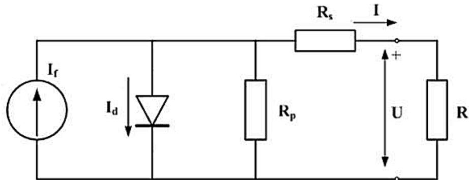
Slika 3.13. FN ćelija kao izvor istosmjerne struje [17]
