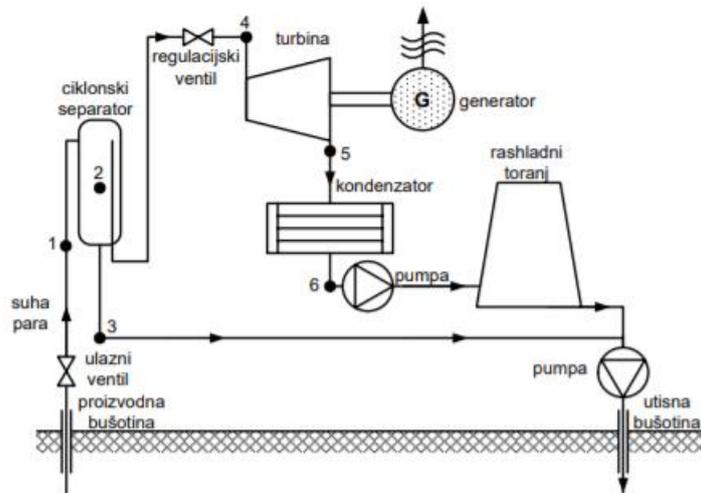
Slika 3.25. Osnovna shema geotermalne elektrane sa isparavanjem [9]
