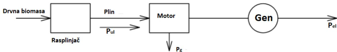
Slika 3.5. Shema procesa dobivanja električne energije rasplinjavanjem biomase [11]
