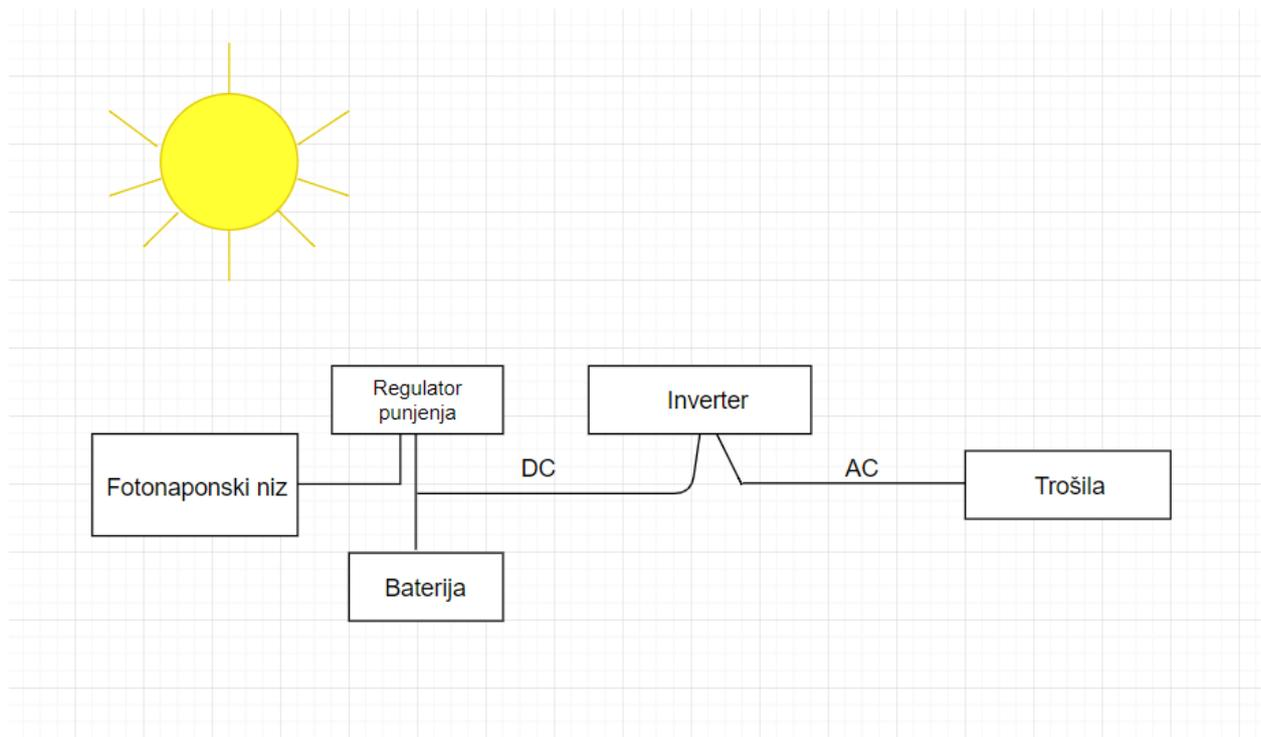
Slika 3.16. Shematski prikaz off-grid fotonaponskog sustava [20]
