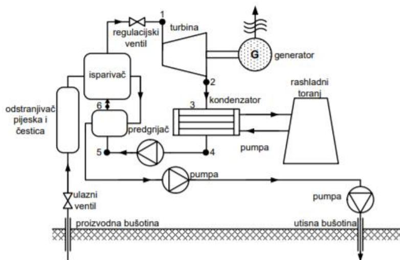
Slika 3.26. Princip rada geotermalne elektrane s binarnim ciklusom [9]
