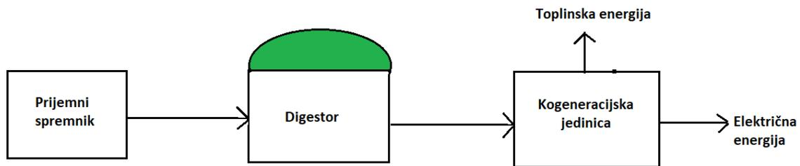
*Slika 3.7. Pojednostavljeni princip rada bioplinskog postrojenja [11]*
