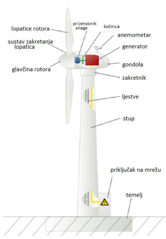
Slika 3.20. Dijelovi vjetroelektrane [25]
