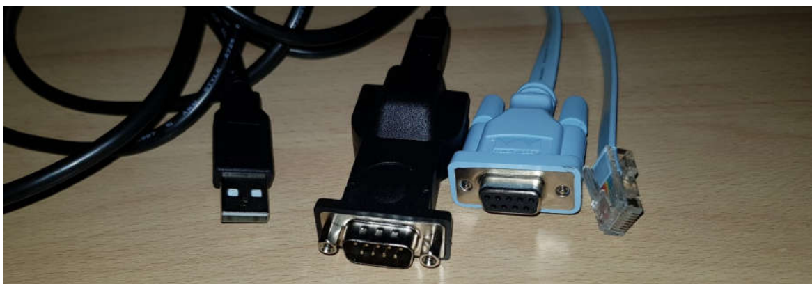
Sl. 5.10. Konzolni kabel (desno) i adapter na USB (lijevo)
