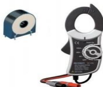
Sl 3.3. Primjeri strujnih mjernih transformatora [6]
