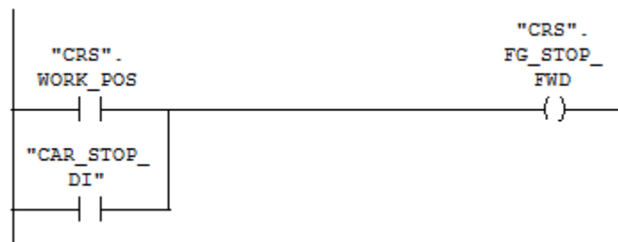
Slika 5.16 Prekid bitovne zastavice za kretanje naprijed
