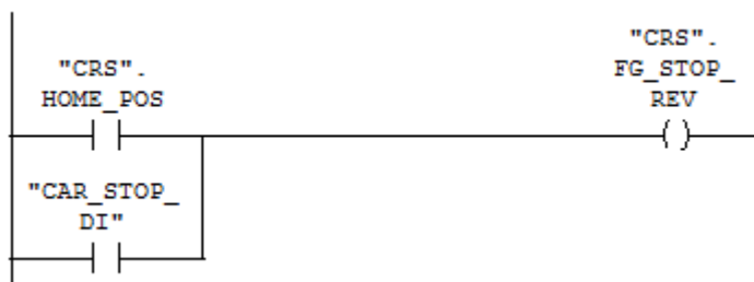
Slika 5.17 Prekid bitovne zastavice za kretanje unatrag
