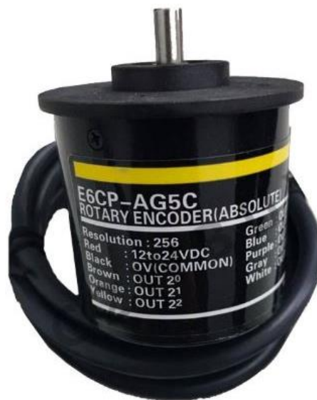
Slika 4.1 Omron apsolutni davač pozicije rotirajućeg tipa [10]
