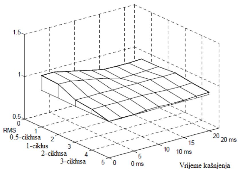
**6.20.** Utjecaj propada tijekom zasićenja transformatora na zaštitu [8]
