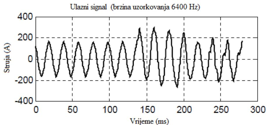
**Slika 6.19.** Struja zasićenog transformatora tijekom propada napona (Švedska)[8]
