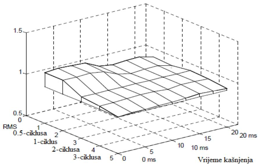
Slika 6.26. Utjecaj struje isprekidanog opterećenja na zaštitu [8]
