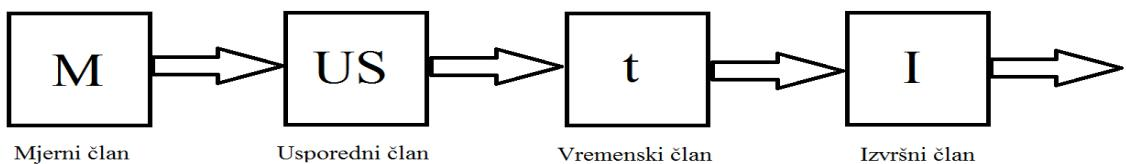
**Slika 3.1. Blok shema statickog releja [3]**
