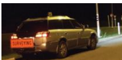
Slika 53. Lux mapping automobil [77]
