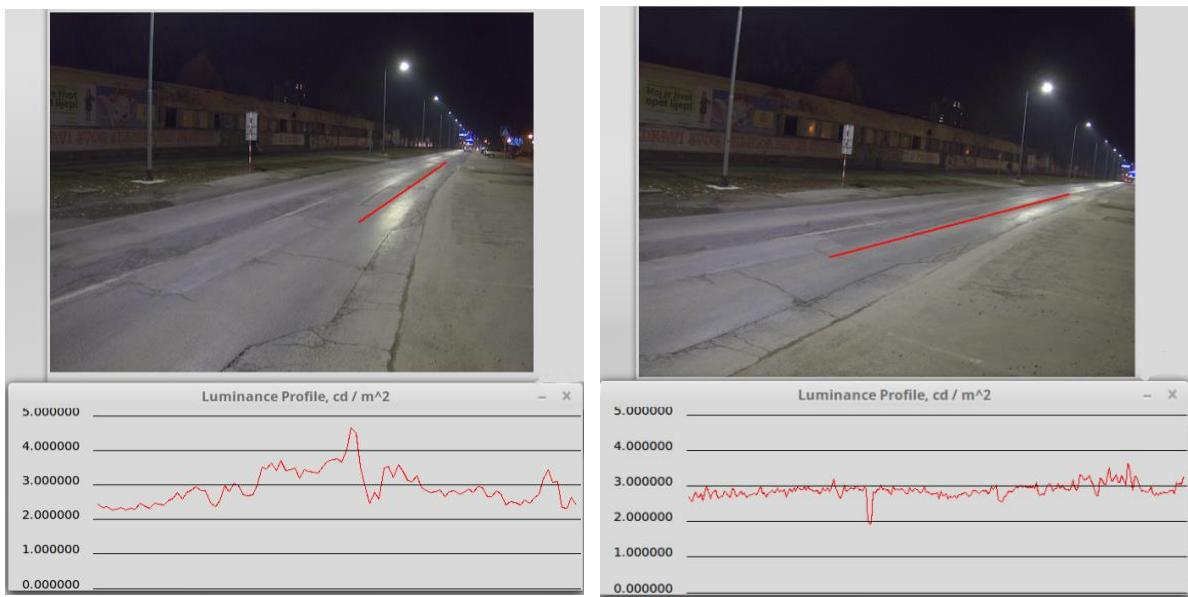
*Slika 65. Oštri kut fotografiranja [91]*
