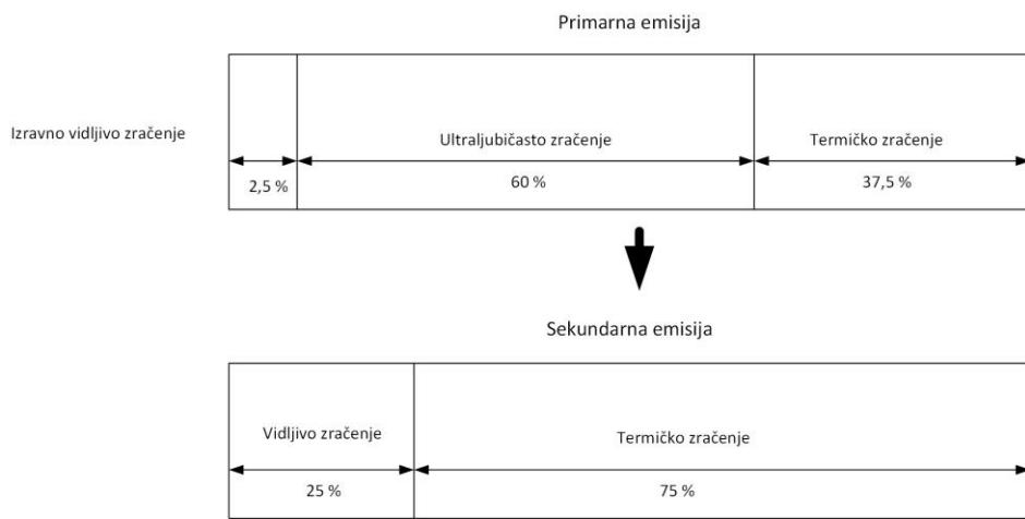
Slika 16. Energetska bilanca zračenja fluorescentne cijevi [17]
