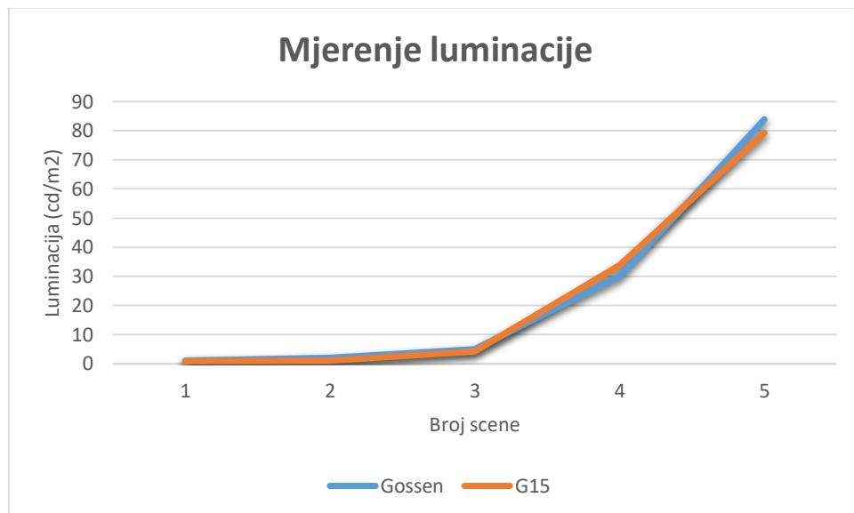
Dobiveni podatci govore o odstupanju Gossen mernog instrumenta od mernih rezultata dobivenih analizom fotografija dobivenih G15 fotoaparatom. Iz rezultata se uočava, uz izuzeće 4. točke, tendenciju mernog instrumenta da pokazuje veće vrijednosti. Ovo saznanje govori da su rezultati u tablici 25 u svih 33 točke mjerena previsoki te su stvarne vrijednosti niže. Zbog toga se mogu očekivati niže vrijednosti od  $3 \text{ cd/m}^2$  prilikom mjerena i analize fotografija dobivenih fotoaparatom.
