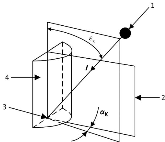
Slika 34. Pravci potrebni za izračun polu-cilindrične osvijetljenosti
