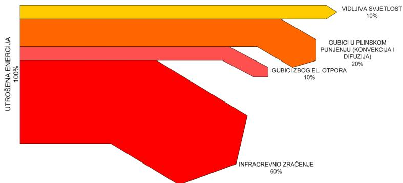
Slika 5. Energetska bilanca halogene žarulje [14]
