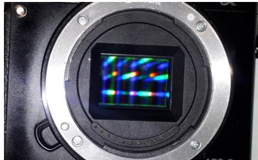
Slika 57. CMOS senzor [81]
