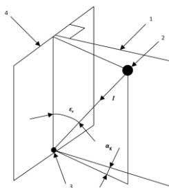
Slika 35. Kutevi korišteni u izračuni okomite osvijetljenosti
