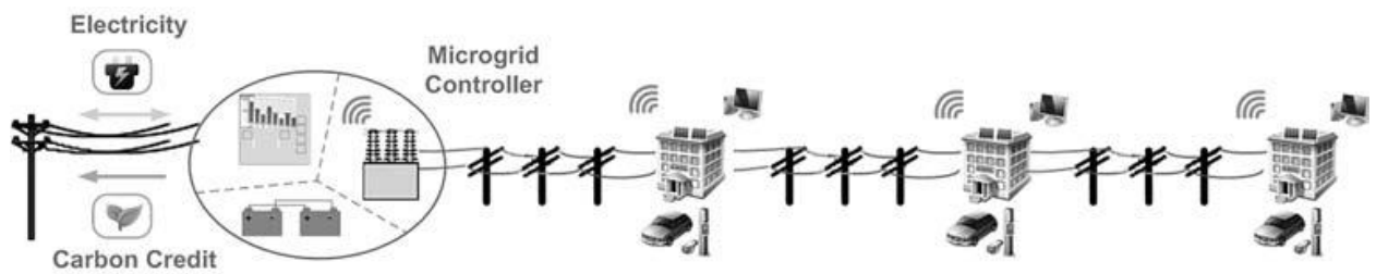
Slika 2.6. Mikromreža na distribucijskom vodu [1]
