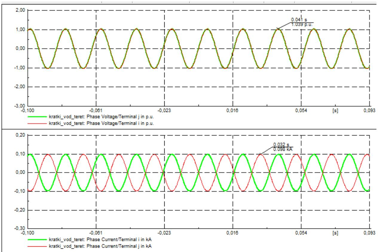
Slika 5.18. Valni oblici struje i napona prije kvara
