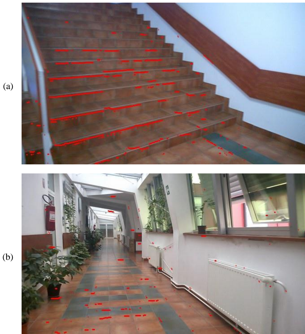
Slika 4.6. Točke na mjestima gdje su vertikalnom analizom uočene potencijalne stepenice na slici: (a) sa stepenicama; (b) bez stepenica
