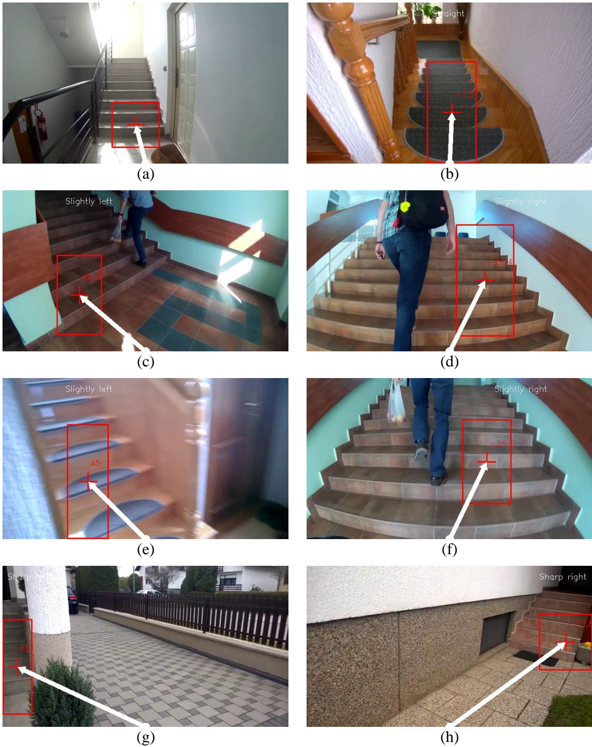
Slika 6.9. Primjeri usmjeravanja na stepenicama: (a) ravno ( 14.2^\circ ); (b) ravno ( -2.5^\circ ); (c) blago lijevo ( 49.6^\circ ); (d) blago desno ( -26.4^\circ ); (e) blago lijevo ( 45^\circ ); (f) blago desno ( -25.6^\circ ); (g) oštro lijevo ( 65^\circ ); (h) oštro desno ( -53.8^\circ )
