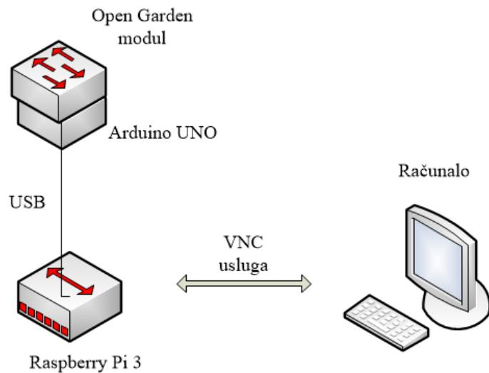
*Slika 4.6. Shema spajanja sustava vlastitog rješenja*
