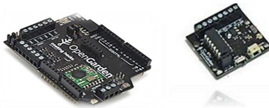
Slika 3.3. Modul za prenošenje podataka i udaljeni modul za prikupljanje parametara
