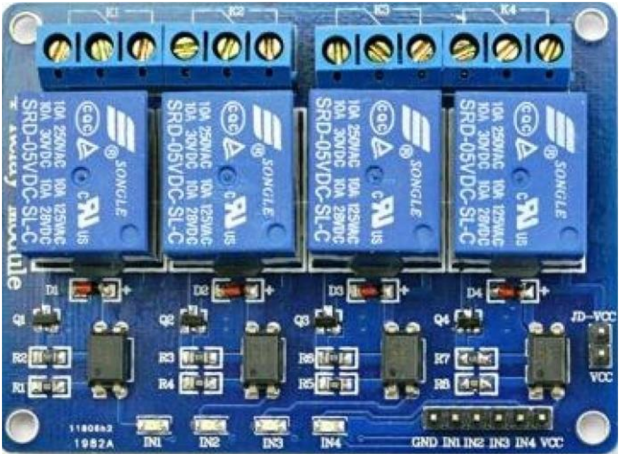
Slika 2.4. 4-kanalni relejni modul [5]
