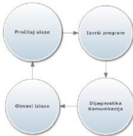
Slika 3.2. Osnovni način rada PLC-a [2]
