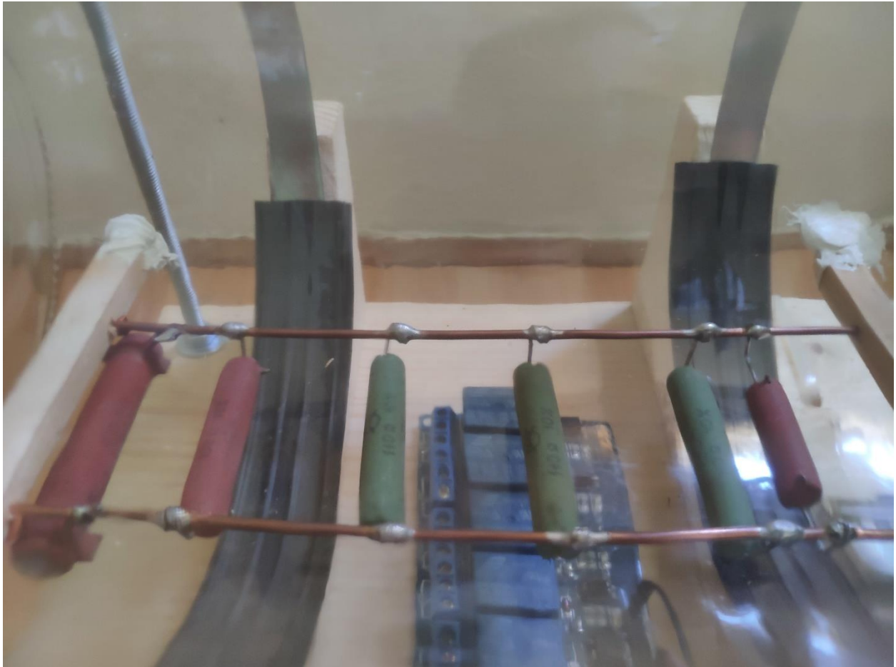
Slika 18. Grijači (žičani otpornici)
