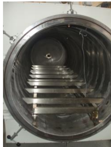
Slika 7. Prikaz cjevastog oblika komore
