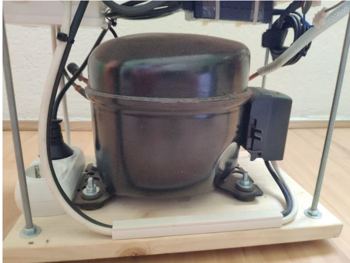
Slika 13. Vakuum crpka-kompresor, prednja strana
