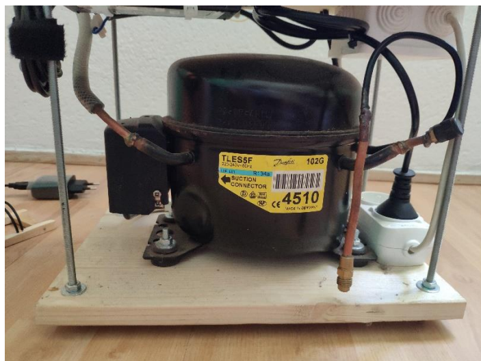
Slika 14. Vakuum crpka-kompresor, zadnja strana
