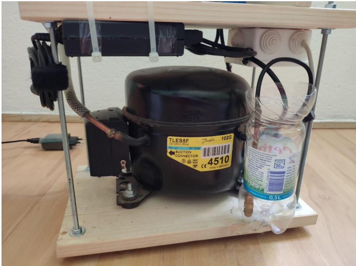
Slika 22. Ispuštanje kondenzata
