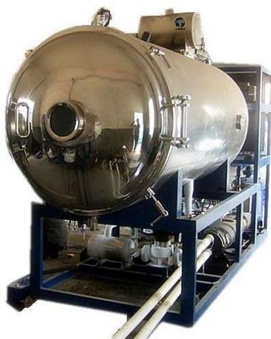
*Slika 2. Primjer vakuum sušare*
