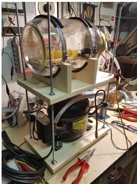
Slika 8. Testiranje realizirane sušare
