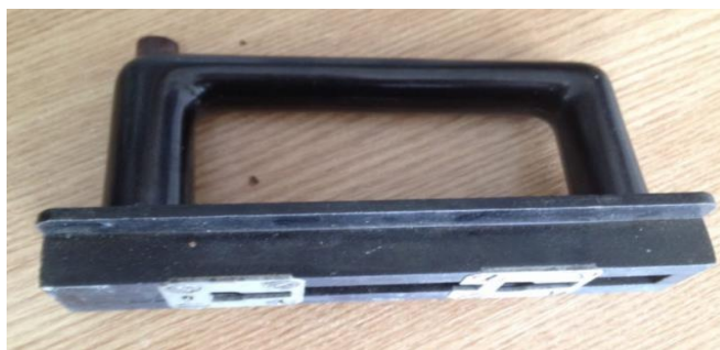
Slika 3.8. Izolacijska ručka HRC osigurača
