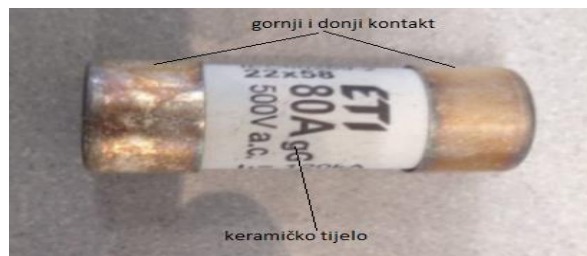
Slika 3.13. Cilindrični uložak marke ETI, razreda gG, nazivne struje 80 A
