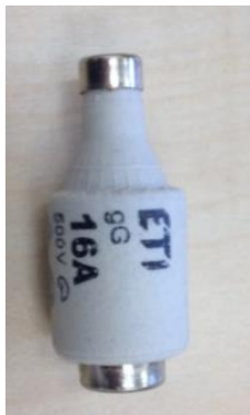
Slika 3.10. Uložak DIAZED osigurača marke ETI, gG razreda, nazivne struje 16 A
