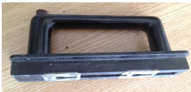
Slika 3.8. Izolacijska ručka HRC osigurača
