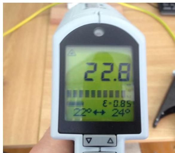
**Slika 5.7.** Raytek infracrveni termometar
