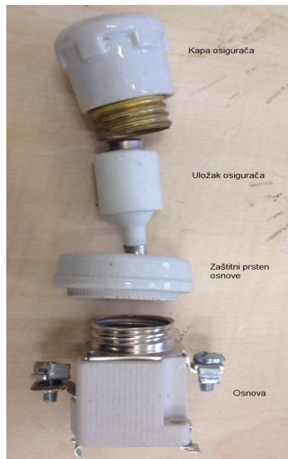
Slika 3.5. Dijelovi DIAZED osigurača
