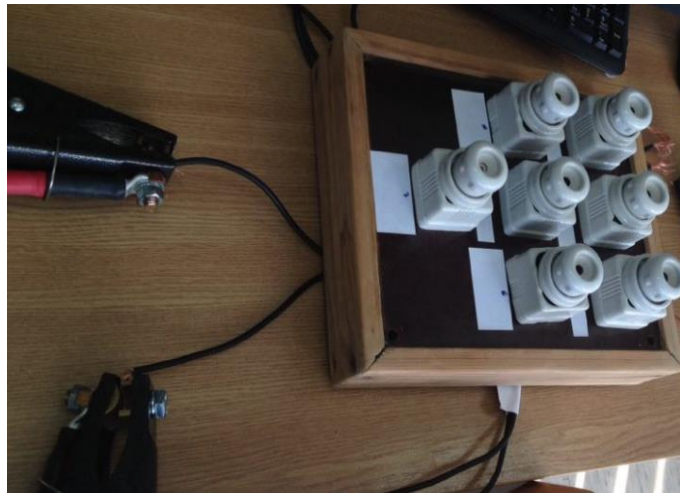
Slika 5.11. Spoj strujnog izvora s osiguračem
