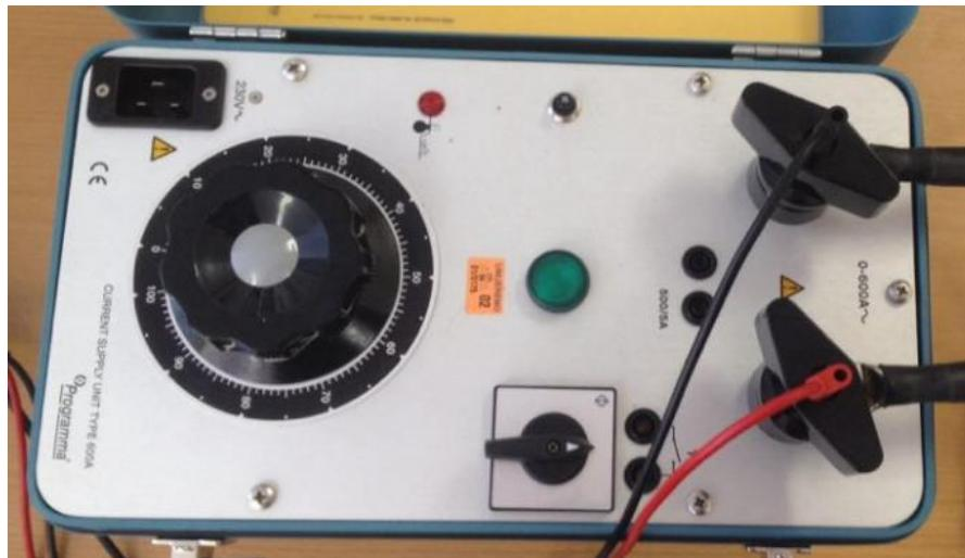
**Slika 5.5.** Strujni izvor Megger CSU600A/AT
