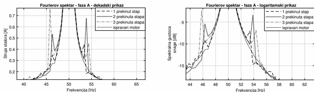
Sl. 4.21: Usporedba bočnih harmonika za slučajevе s 0, 1, 2 i 3 slomljena štapa kaveza rotora
