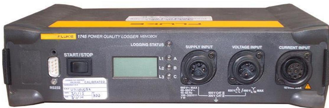
Slika 4.1. Uređaj za mjerenje FLUKE1745 [9]
