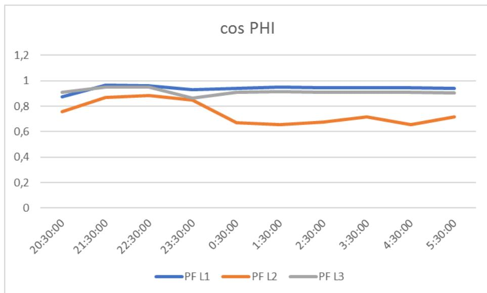
Slika 4.9. Grafikon mjerena faktora snage
