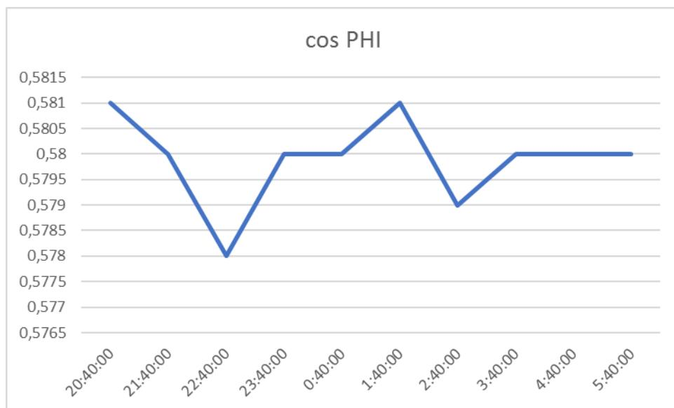
*Slika 4.22. Grafikon mjerena faktora snage*
