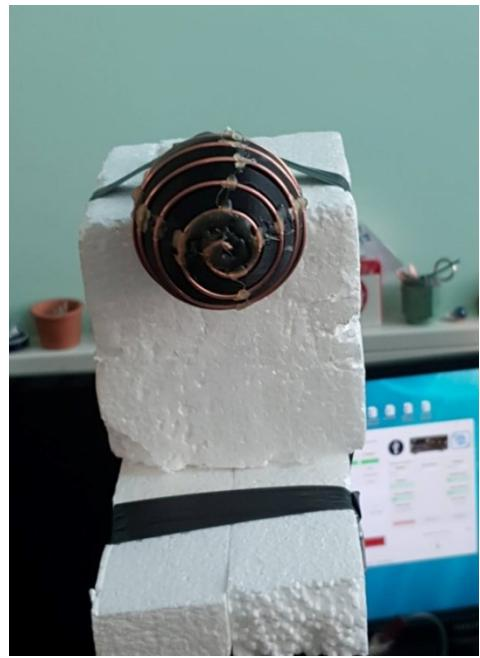
Sl.4.36. Mjerenje jakosti polja u laboratoriju u vertikalnoj ravnini za L5 (POLOŽAJ 1)
