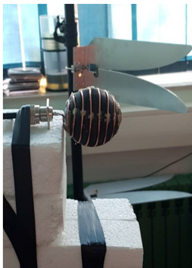
Sl.4.38. Mjerenje jakosti polja u laboratoriju u vertikalnoj ravnini za L5 (POLOŽAJ 2)
