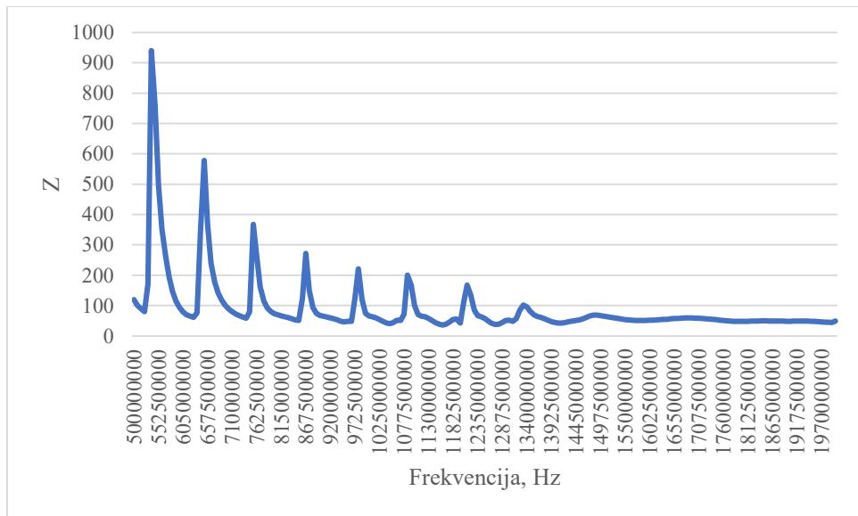
Sl.4.12. Ovisnost absolutne vrijednosti impedancije o frekvenciji za antenu L8.
