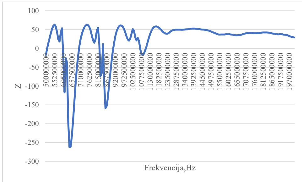
S1.4.19. Ovisnost realnog dijela impedancije o frekvenciji za antenu L5R.
