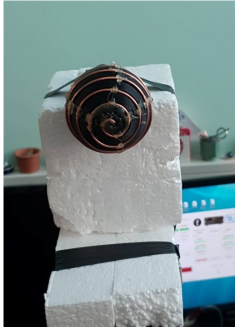
Sl.4.36. Mjerenje jakosti polja u laboratoriju u vertikalnoj ravnini za L5 (POLOŽAJ 1)
